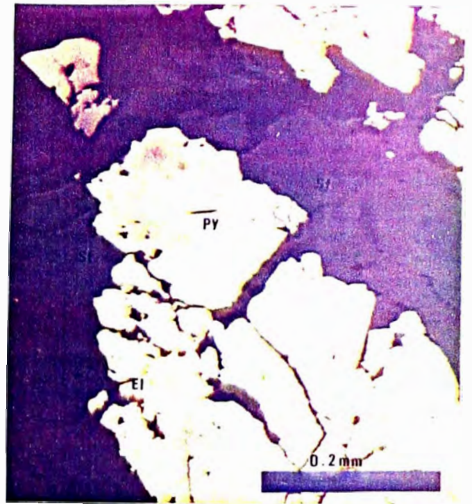
M.F.9.- Sección pulida de una muestra en la veta La Lima, se observa electrum en pirita, arsenopirita y cuarzo.
