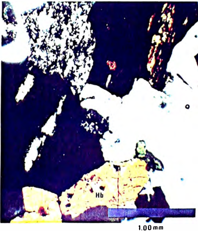
M.F.6-M.F.7.- Sección delgada en Nx. y en N//. de una granodiorita del "Batolito", se aprecia cuarzo, plagioclasas sericitizadas, hornblenda cloritizada y ortoza.
