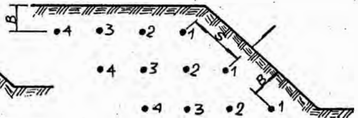
(D) CORTE LATERAL EN ESCALON
