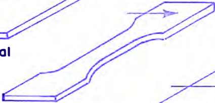
Prueba de tension plana transversal
