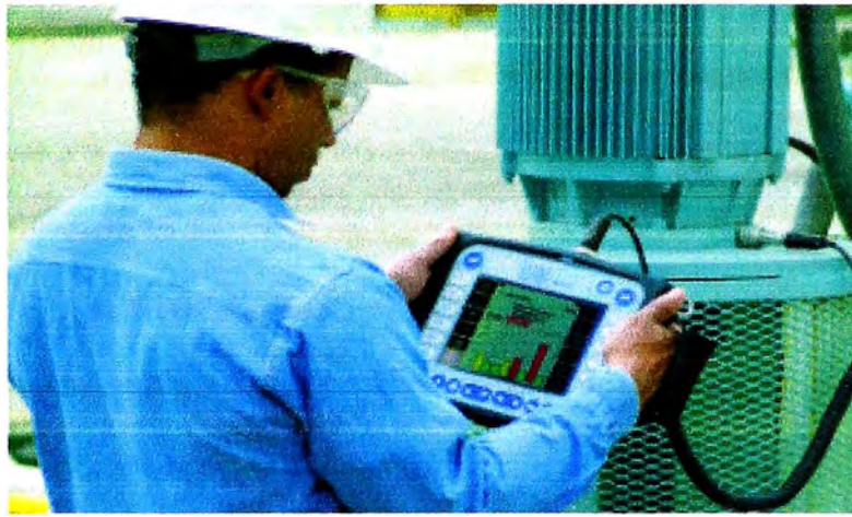
Fig. 4.4 Análisis Vibracional con equipo portátil haciendo monitoreo en campo
