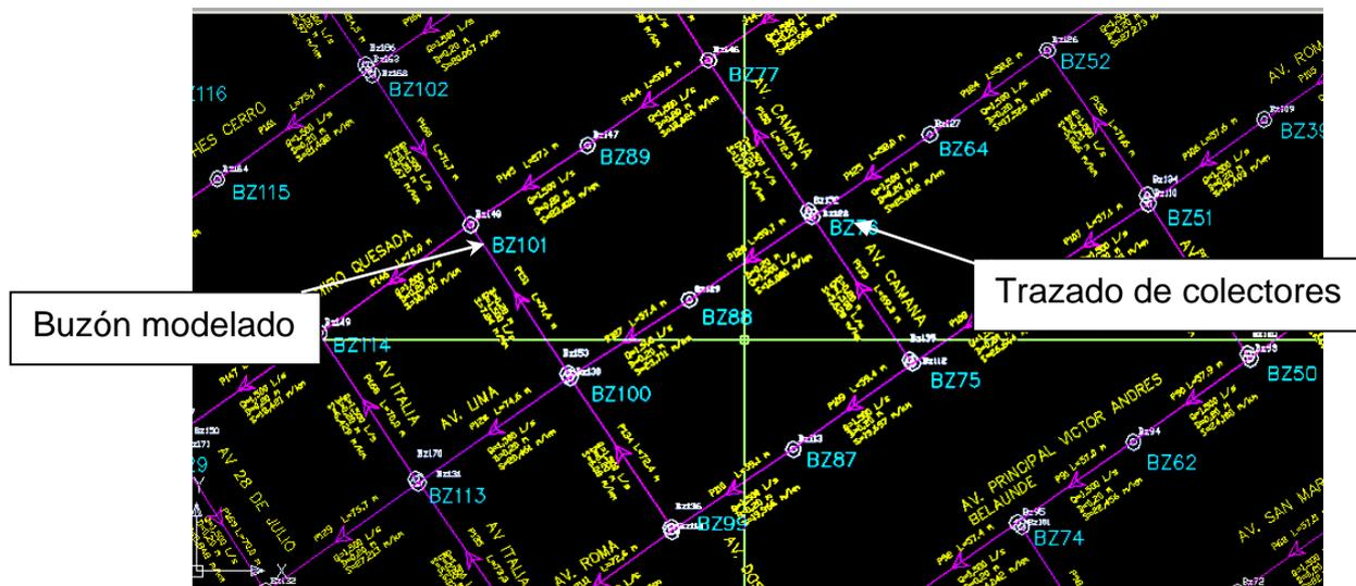
Figura N° 3.4 Trazado de tuberías empleando la barra de prototipos
