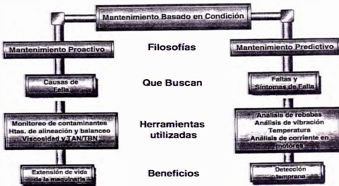
Fig. 3.6 Estrategias Modernas de Mantenimiento (Ref. Seminario de Mantenimiento Proactivo mediante análisis de aceite 2001-Noria Latin America)
