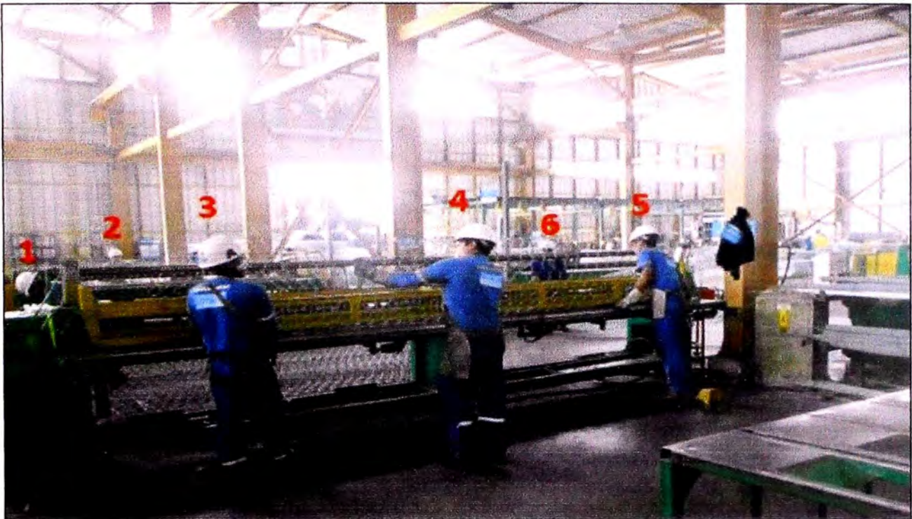
Fig. 4.9 Área de Trabajo: Armado de Gaviones Fuente: Planta PRODAC
