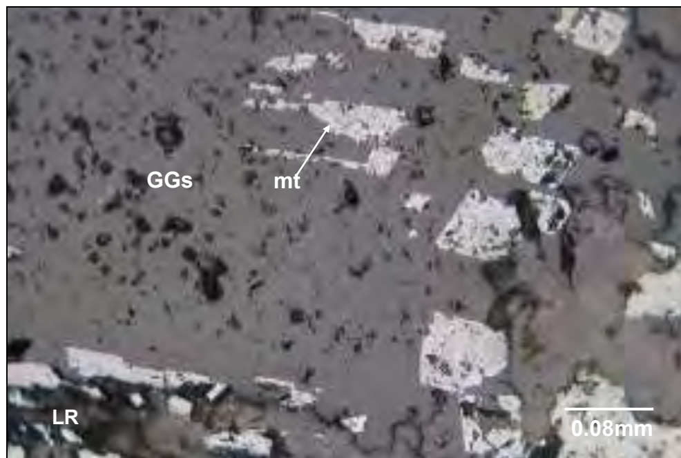
Figura 6. 2: Fotomicrografía LR, magnetita (mt) con hábitos cúbicos relleno de cavidades por toda la muestra. LR: Luz reflejada
