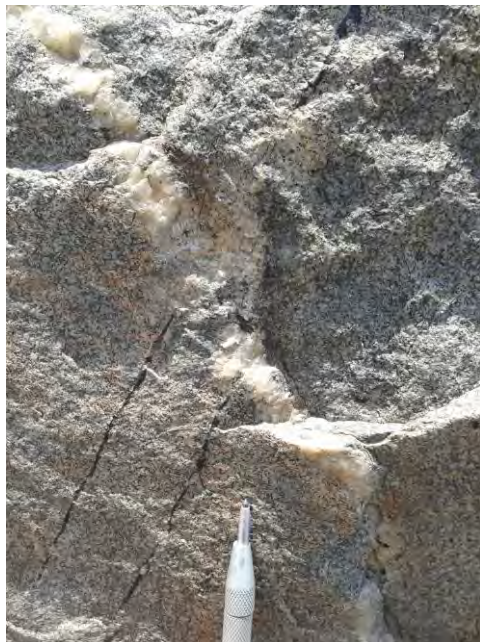
Figura 4. 7: Venilla de cuarzo (qz) de 1cm cortando venillas de magnetita (mt) de 0.2 cm
