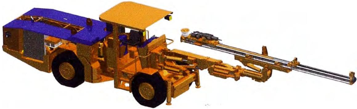
Figura 2.1 – Equipo de Perforación para minería subterránea
