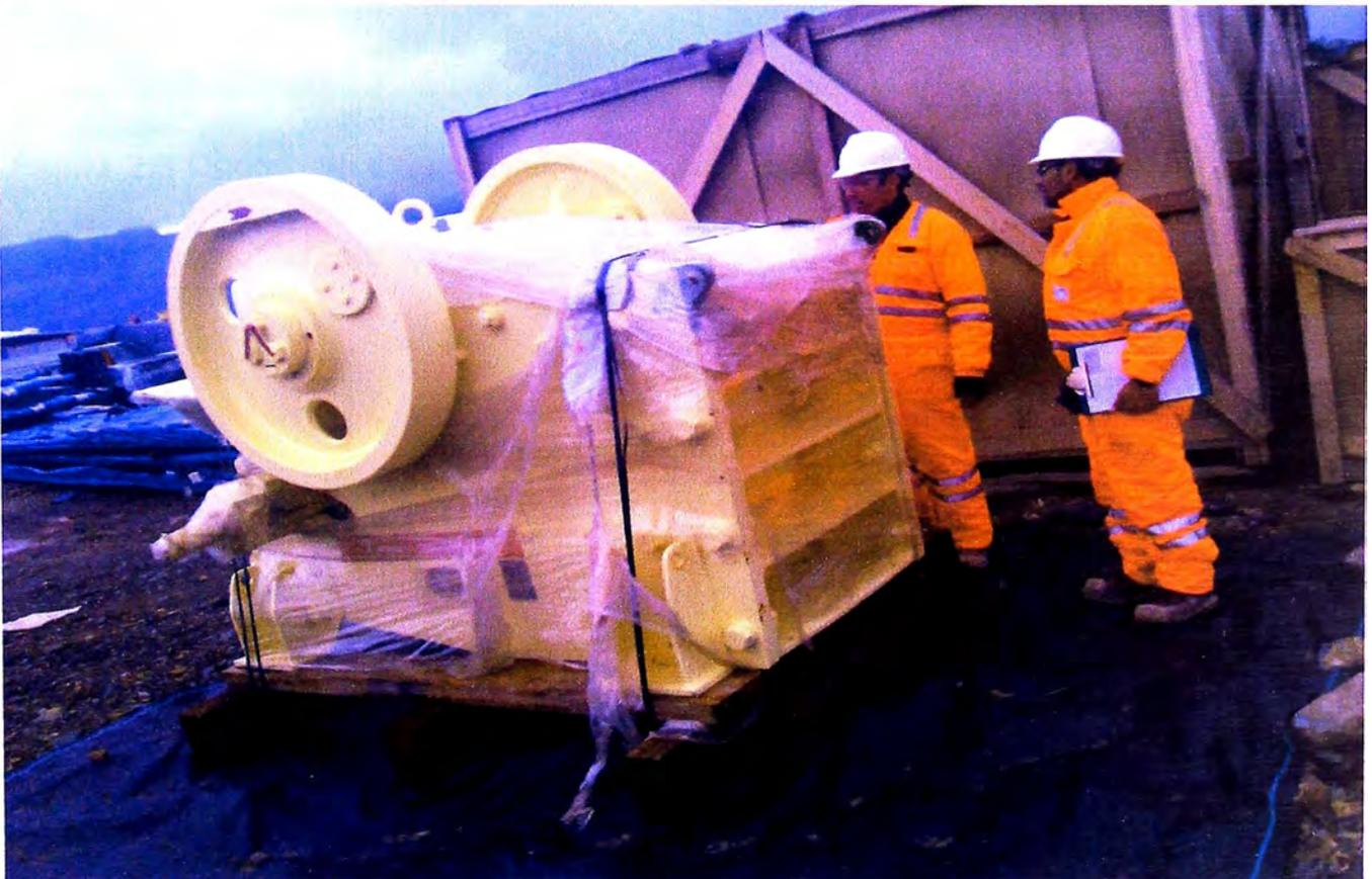
Figura 2.2 Cuerpo de Chancadora Primaria de mandíbulas METSO C80
