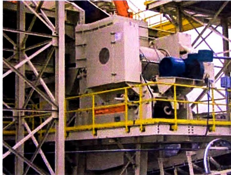
Una C145 durante la fase de instalación en una nueva planta de trituración primaria.
