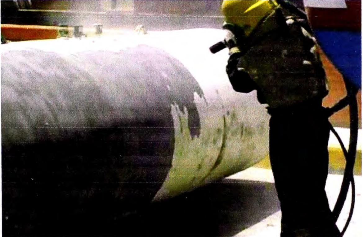
Fig.4.1 Limpieza por Granallado
