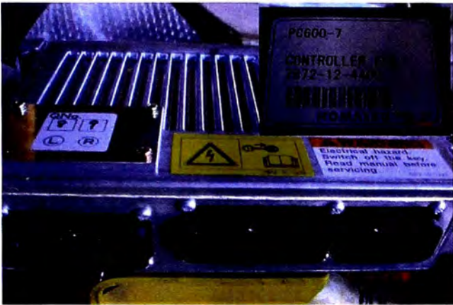
Fig. 4.4 Controlador original (estandar) P/N 7872-12-4400.
