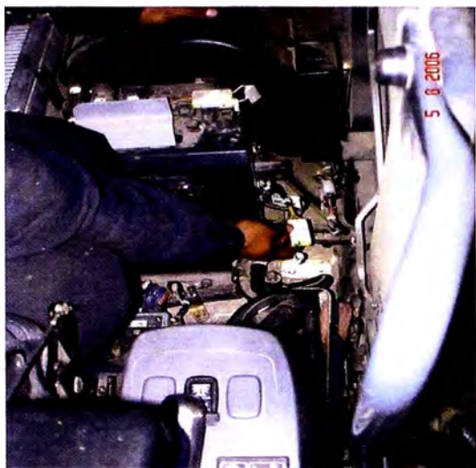
Fig. 4.8 y 4.9 Instalación del ECU juntos con el conector N° 2 dentro de la cabina.
