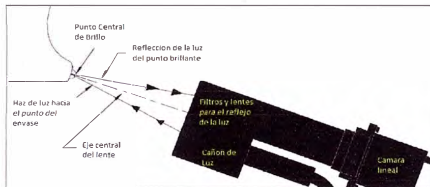
Figura 2.3.7: Configuración de Cabezal de lectura del CID4
