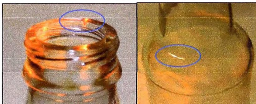
Figura 2.3.4: Incidencia de luz sobre grietas en envases de vidrio
