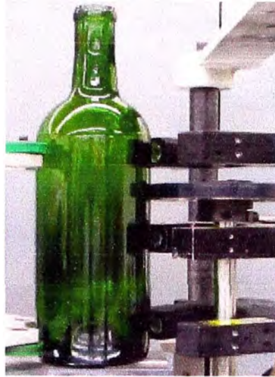
Figura 2.3.26: Montaje de sondas de OTG en 3 puntos del cuerpo.
