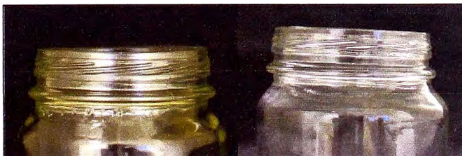
Figura 2.3.23: Defectos en el terminado detectados por el WOF
