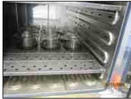
Figura 3. 34: Llevado a la estufa a 105°C con el fin de obtener la materia seca (Año 2009).
