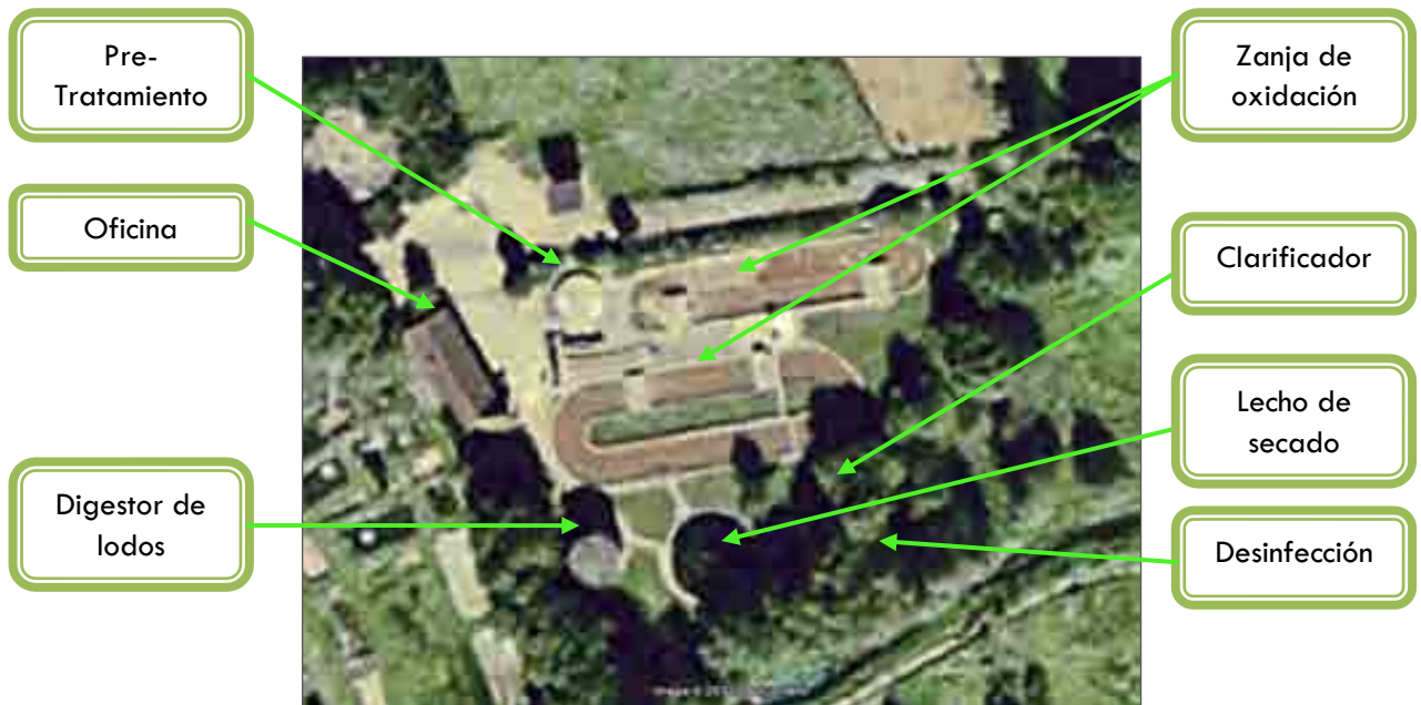
Figura 1: Vista panorámica de la PTAR de lodos activados de Suderburgo señalando las partes del sistema.
