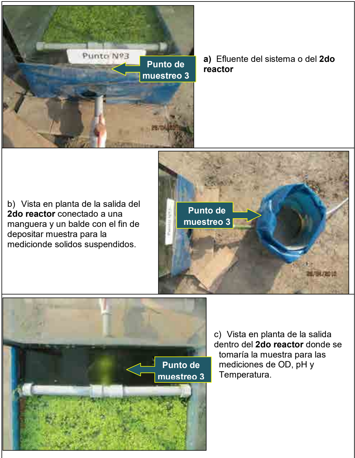
Figura 3. 46: Tercer punto de medición del sistema de tratamiento (CITRAR-Año 2010)
