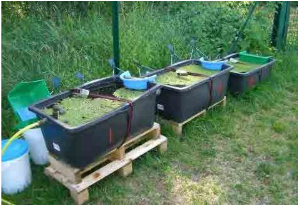
Foto 2. Vista de los sistemas de flujo continuo utilizando Azolla F. en la PTAR-Suderburgo (Alemania)
