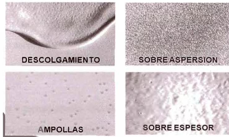
**FIGURA 2.5** Defectos de acabado en la superficie de pintura
