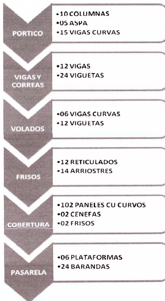
**FIG.1 Secuencia básica de montaje**
