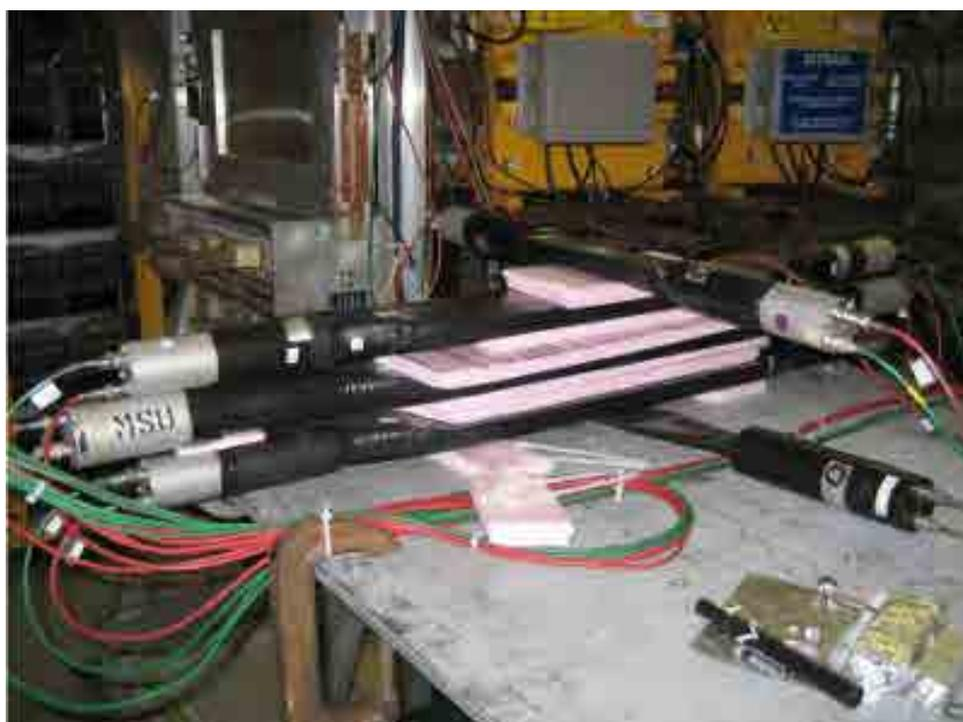
Figura 5.11: Aquí se muestra la disposición de las barras centelladoras con sus respectivos PMTs para la toma de datos, para esta parte se hizo uso de los rayos cósmicos (principalmente muones) para el cálculo de la resolución
