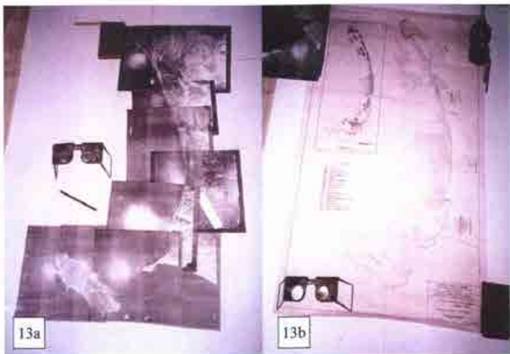
Foto N° 12: Estereoscopio para estudio de diagrama de olas y línea de costa. Foto N° 13: Mosaico de fotos aéreas del SAN, escala 1:30,000 (a) y diagrama de olas (b)
