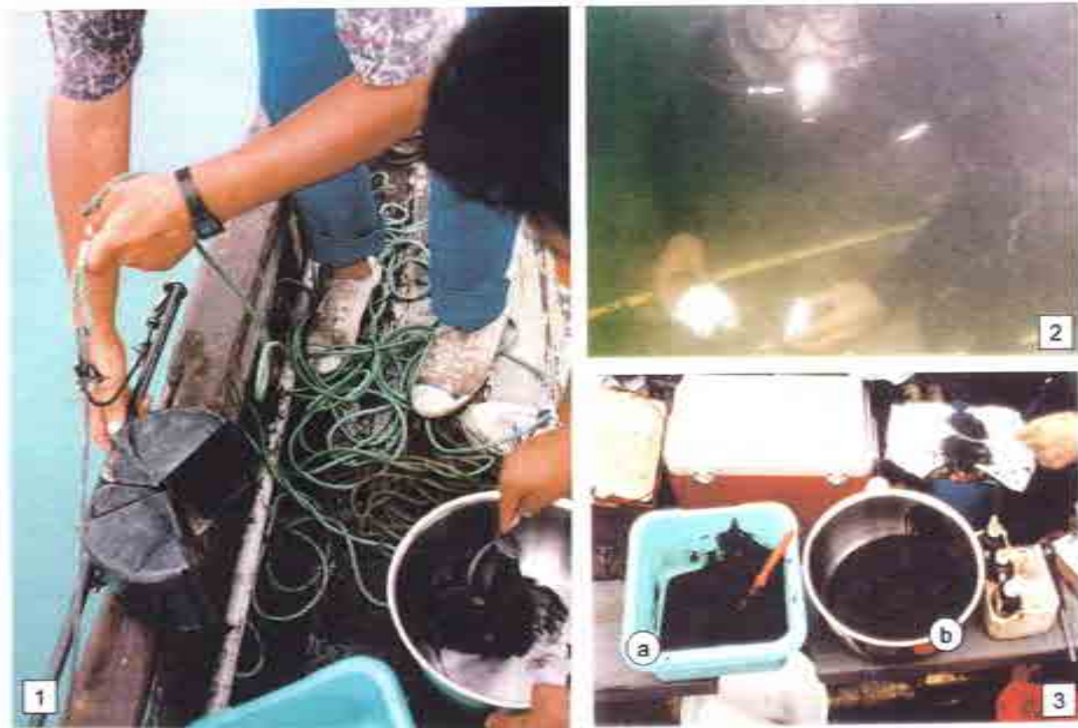
Foto N° 1: Muestreo del fondo marino mediante una draga tipo Van Veen. Foto N° 2: Muestreo mediante buceo. Foto N° 3: Selección y almacenamiento de muestras para diferentes análisis (inferior derecha). (a) Para metales traza y (b) para hidrocarburos.
