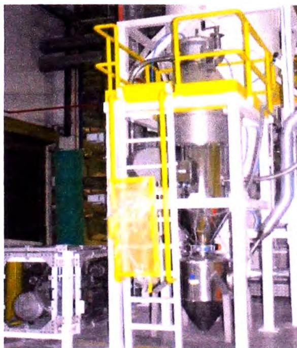
Figura 4.14 – Bomba de vacío y filtro en línea.
