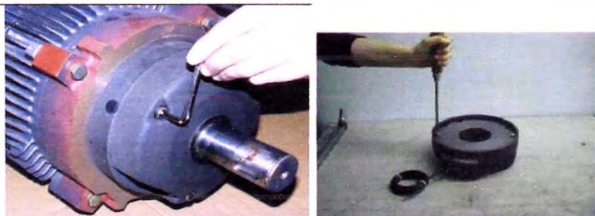
FIGURA 2.20. Ubicación de frenos de izaje tipo electromagnético
