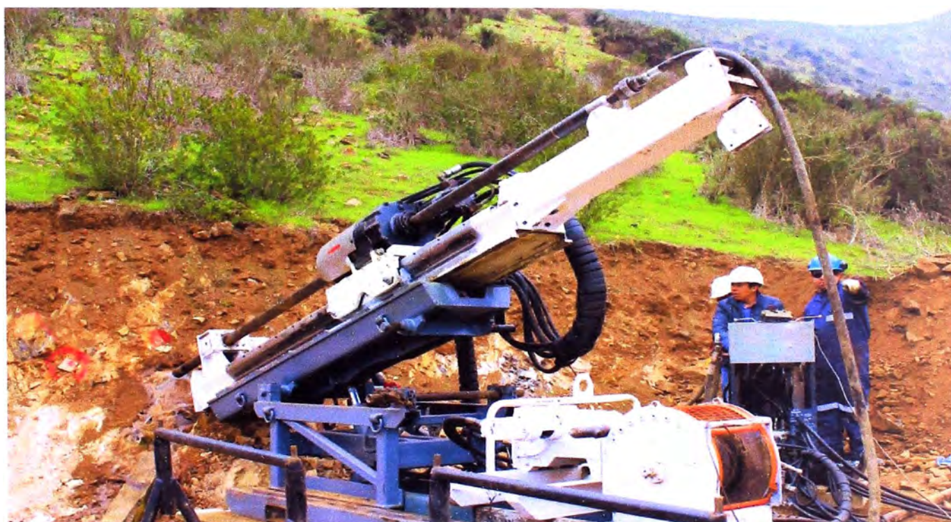
FIG. 2.7 Equipo ONRAM 1500 Marca Sandvik
