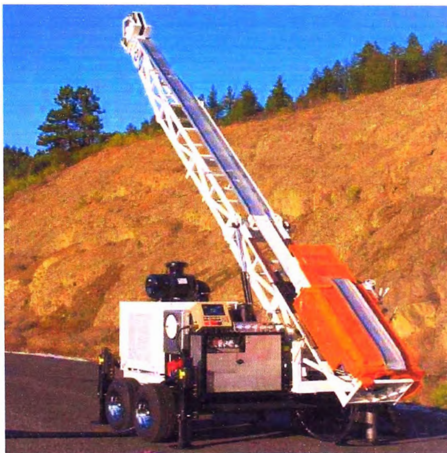
FIG. 3.2 Equipo de perforación Diamantina LF90
