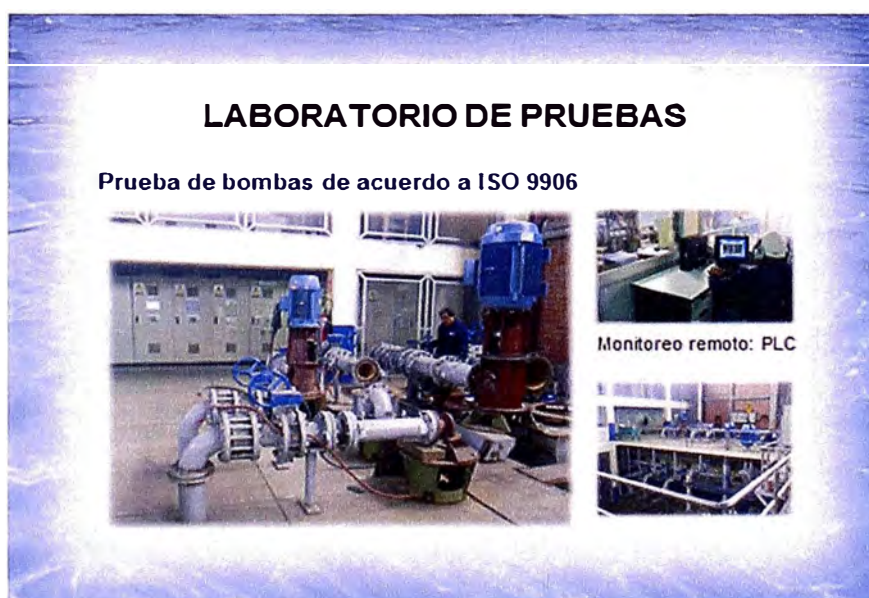
Figura 7.7 Prueba de bomba turbina vertical en laboratorio
