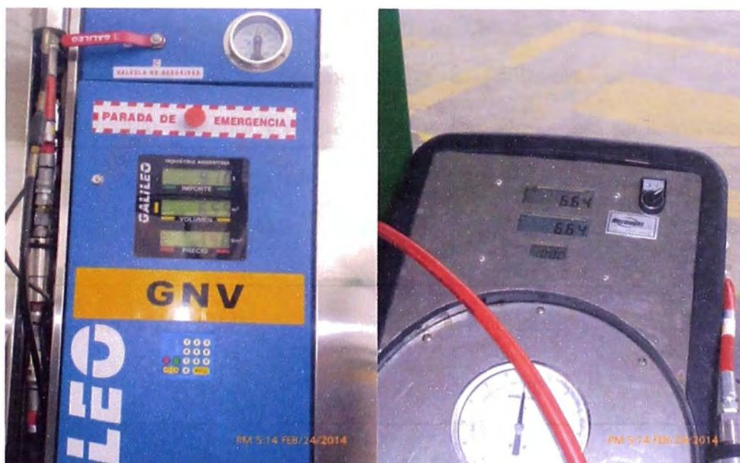
**Figura 3.47** Verificación de la Calibración en Dispensadores.
