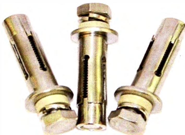
Figura N° 3.3: Anclajes con pernos de expansión utilizados para fijar el mamógrafo al piso, generalmente de 16 mm de diámetro o mayor.
