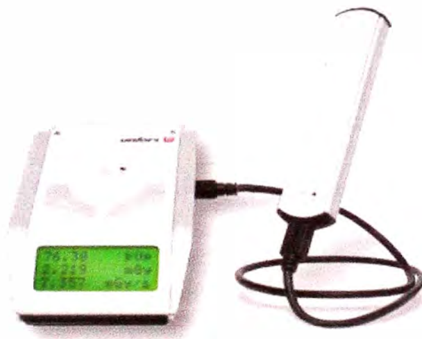
Figura N° 3.4: Medidor de kVp y mAs moderno marca Unfors modelo Xi. Este instrumento utiliza una técnica no invasiva mediante el sensor mostrado especial para mamografía. El sensor asimismo reporta en pantalla otros valores como el tiempo de exposición, la capa hemi reductora (HVL), el tiempo, etc. El Unfors Xi puede medir otros parámetros como mA del filamento de tubo de rayos-x mediante
