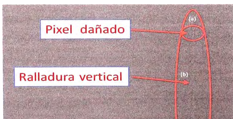
Figura N° 3.6: Defectos típicos en un detector con un pixel defectuoso (a) y con una línea defectuosa (b). Si estos no desaparecen en el aplanado del detector y de acuerdo al grado de severidad podría ser necesario reemplazar el detector.
