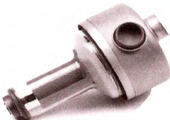
Figura N° 2.1: Tubo de rayos-x marca Varian, especial para mamografía, con ánodo de tipo biangular y alta velocidad de rotación (alrededor de 9500 RPM).
