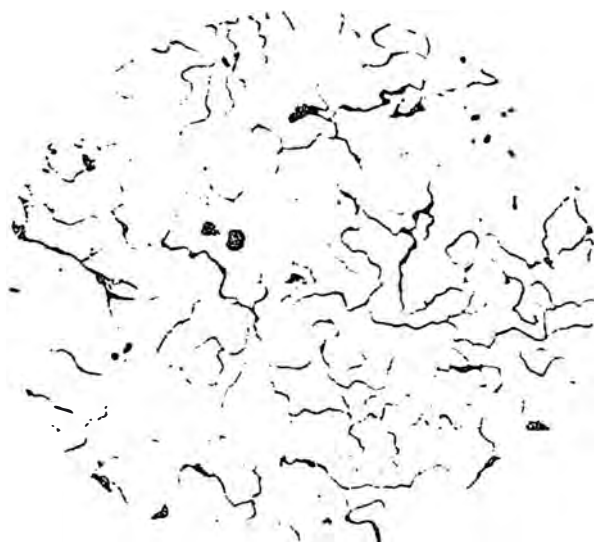
FIGURA 3.67.- Sección de 1". Resistencia a la tracción = 46.90 Kg/mm 2 ; Límite de fluencia = 30.94 Kg/mm 2 ; Elongación = 5.0%
