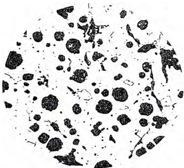
FIGURA 3.65.- Sección de 3/8". C total 3.75%; Si 2.63%; Mn 0.39%; S 0.025%; Mg 0.071%; Pb 0.003%; Sb 0.007%.
