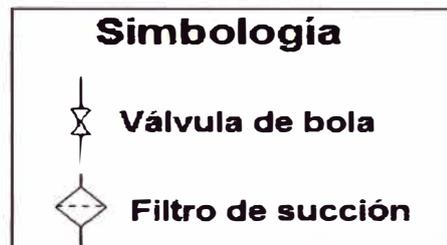
Figura N°6.22 Simbología hidráulica de la válvula de bola y del filtro de succión.
