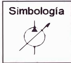
Figura N° 6.38 Simbología hidráulica de una bomba variable.
