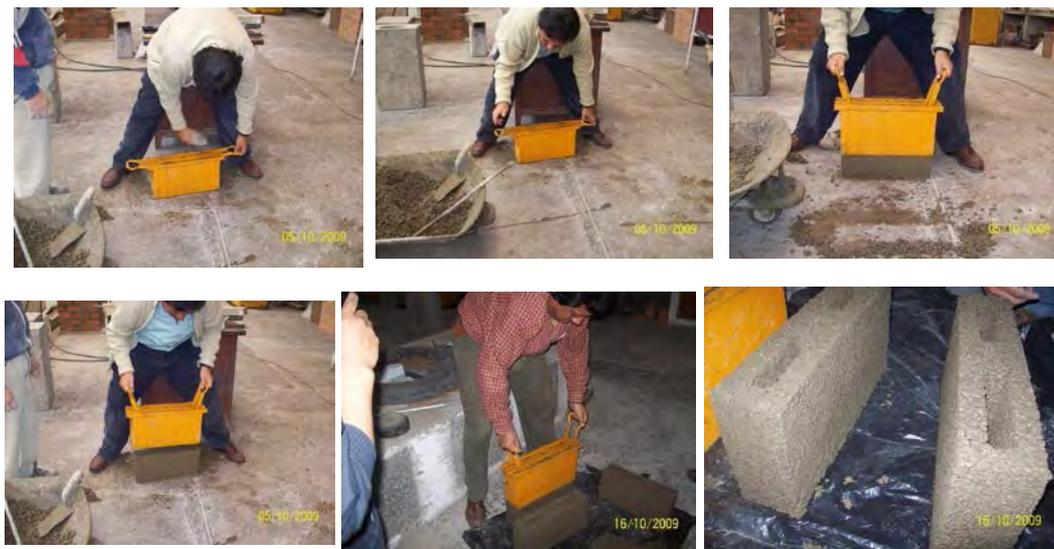
Foto N° 4.02: Proceso de formado de las bloquetas de concreto
