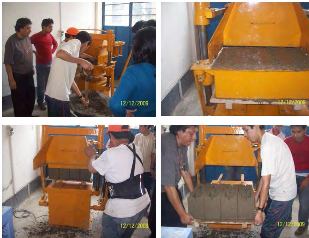
Foto N° 5.26: Proceso de elaboración de bloques de concreto.
