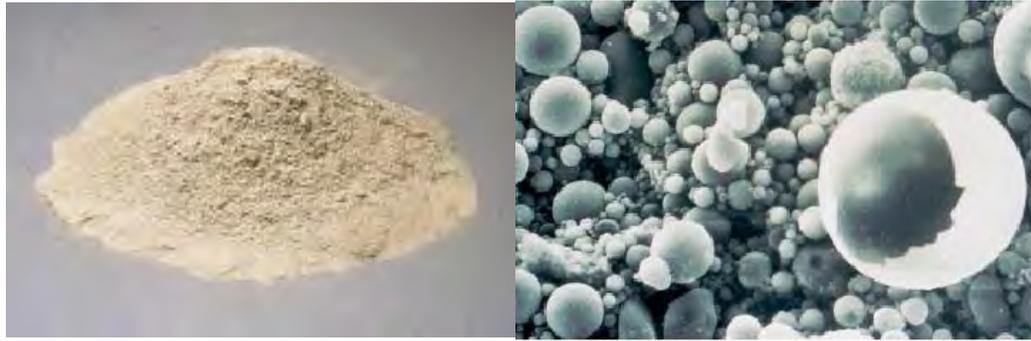
Foto N° 1.05: Ceniza volante y micrografía de partículas de ceniza volante (aumento 1000X).
