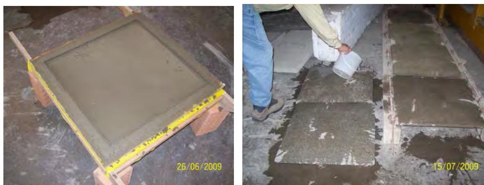
Foto N° 5.19: Domo formado y desmoldado – proceso de curado.
