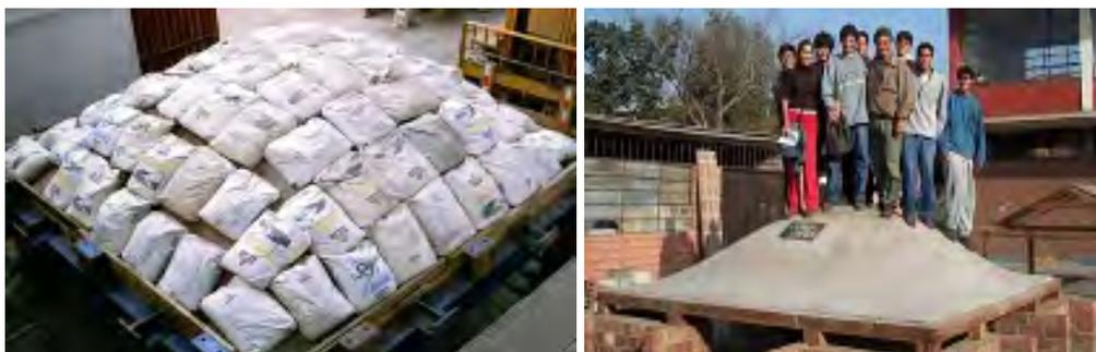
Foto N° 1.10: Prueba de carga en al techo domocaña realizado en el CISMID
