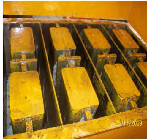
Foto N° 5.05: Tolva de máquina bloquera y vista de los cuatro moldes
