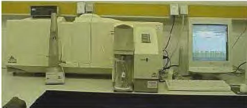
Foto N° 2.15: Equipo de granulometría por difracción láser.
