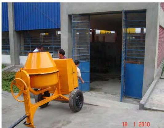
Foto N° 5.02: En la vista se aprecia la mezcladora
