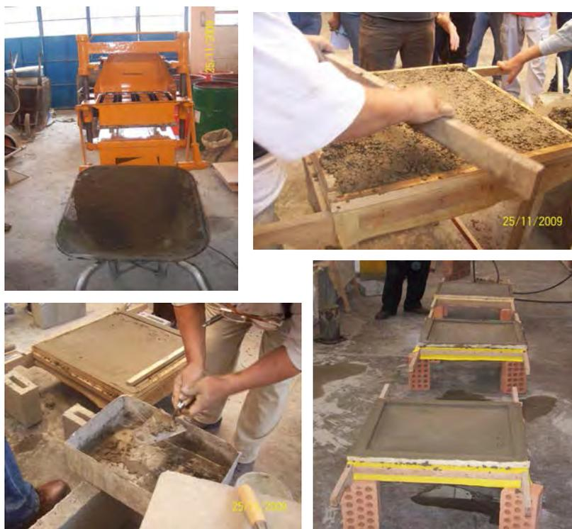
Foto N° 5.18: Proceso de elaborado de los domos de concreto.
