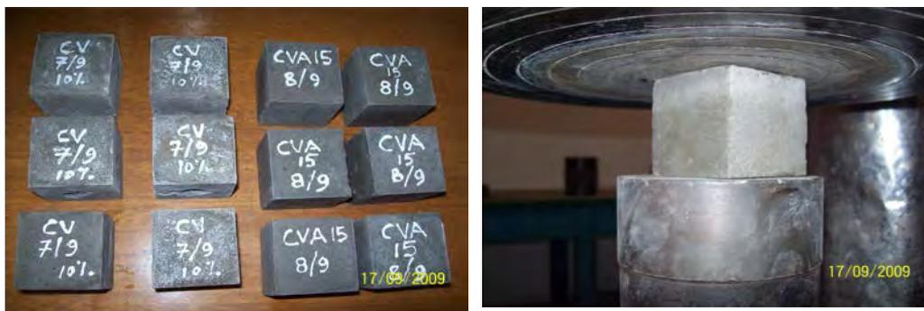
Foto N° 3.02: Ensayo de compresión en mortero de cemento con ceniza de cáscara de arroz.
