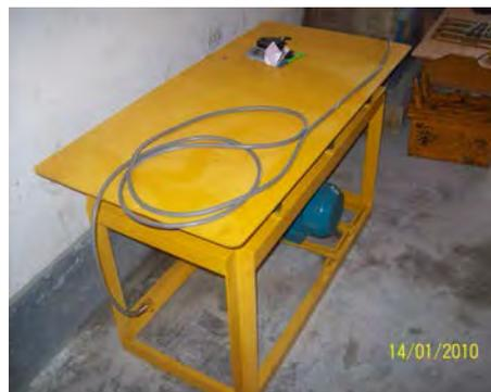
Foto N° 5.06: Mesa vibratora para la vibro compactación del concreto.
