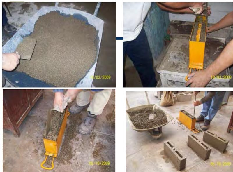
Foto N° 4.01: Proceso de elaborado de las bloquetas de concreto
