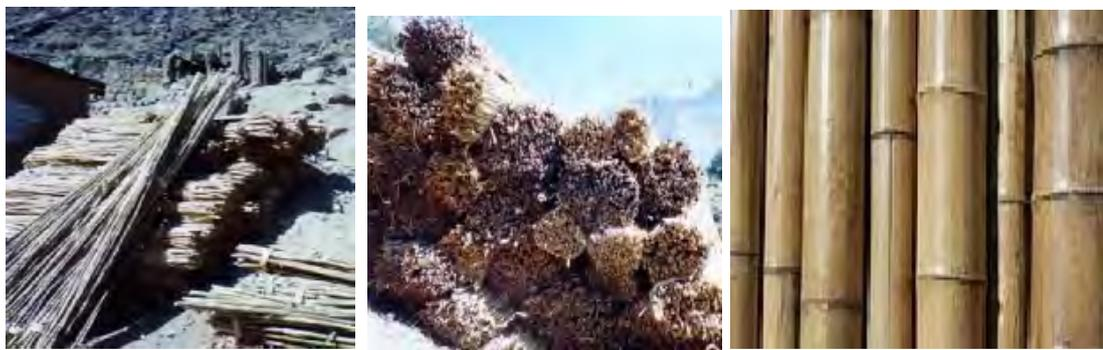
Foto N°1.09: Gramíneas para uso en la construcción de sistemas no convencionales.
