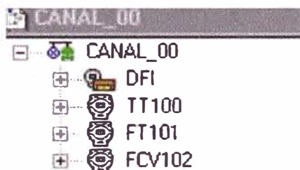
Figura 5.43 Dispositivos agregados en la red Fieldbus.
