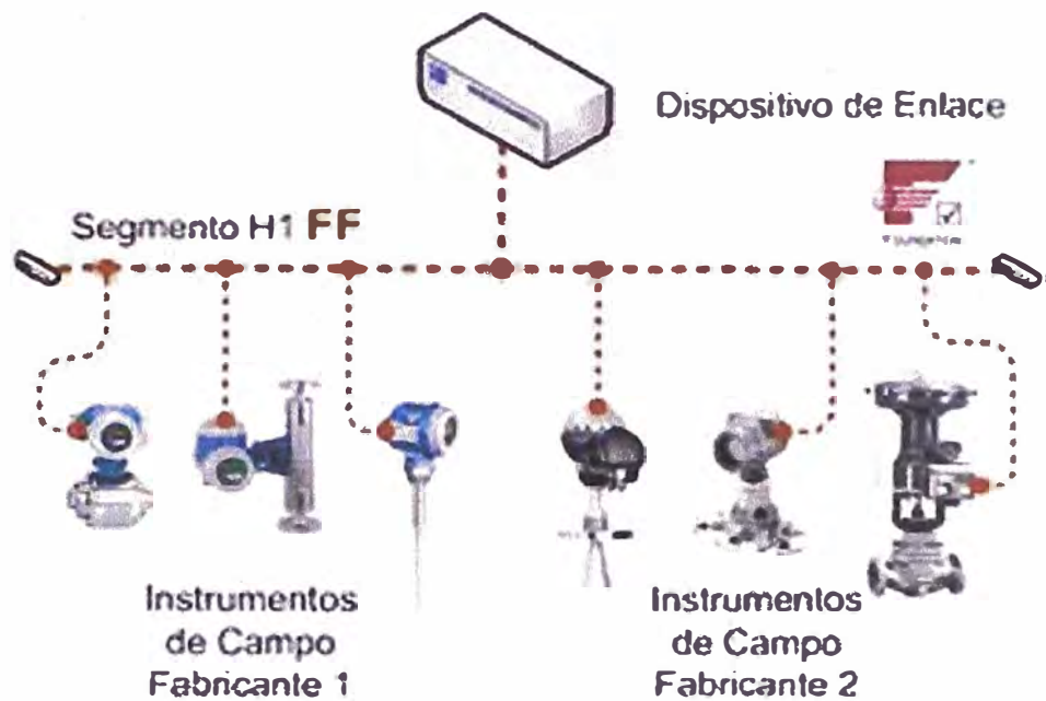
Figura 4.15 Segmento de Foundation Fieldbus.
