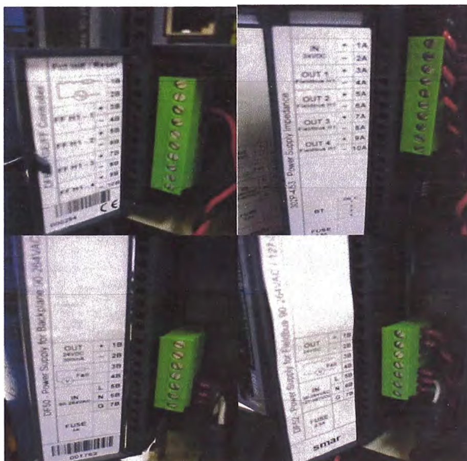
Figura 5.32 Tabla de Conexiones Internas
