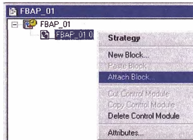
Figura 5.53 Creación de enlace de los bloques.
