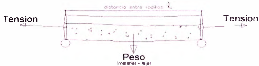
Fig. 4.21.-Distancia máxima entre estaciones
