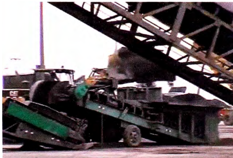
Fig. 3.3.-Descarga de concentrados en fajas portátiles.
