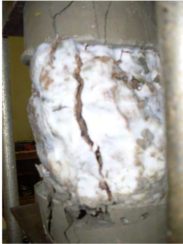
(b) Falla de la muestra en el sentido vertical
