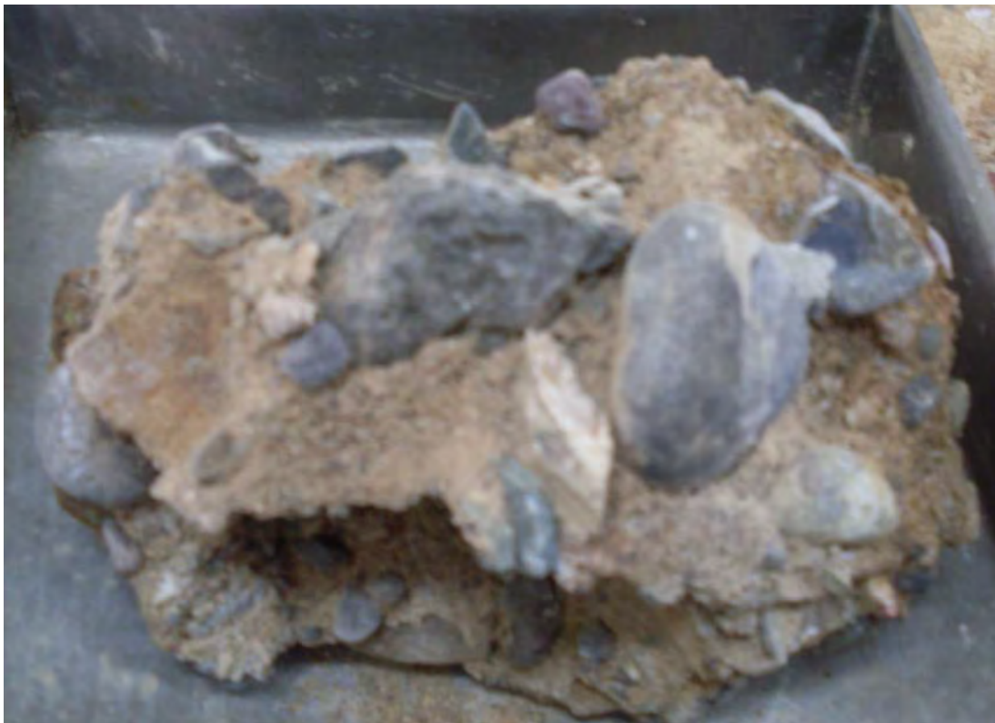
Fig.N°6.01: Conglomerado de la zona de estudio, conformado por guijarros, gravas con matriz arenosa + sales y sulfatos solubles.
