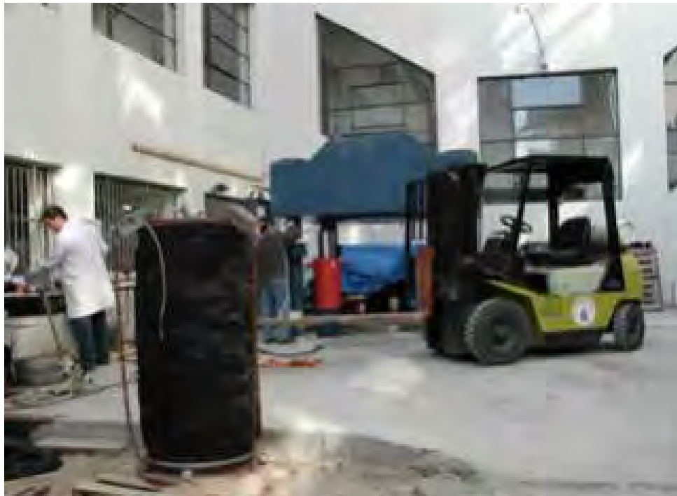
Fig N° 4.02 : Muestra inalterada necesaria para efectuar los ensayos triaxiales
