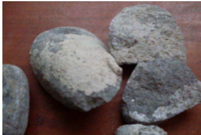
Fig.N° 7.06: Muestras con manchas blancas (sales) que han ocasionado el rompimiento
