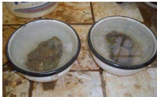
Fig.N° 7.07: Experimento para la identificación del conglomerado colapsable
