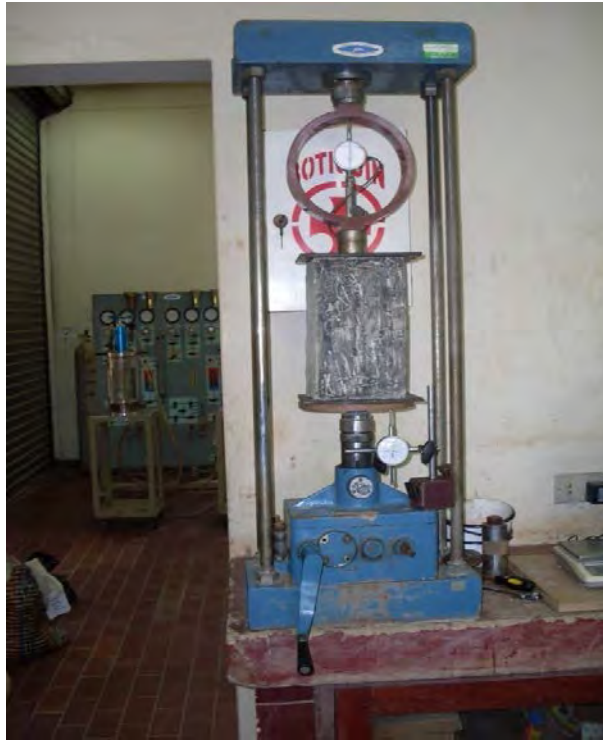
Fig.Nº 7.04: Colocado de la muestra en el equipo de compresión simple antes de iniciar el ensayo
