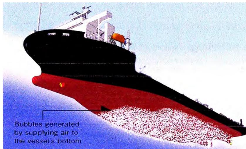
Fig. 3.1 Embarcación que usa sistema de burbuja de aire – en Proyecto Fuente: Mitsubishi
