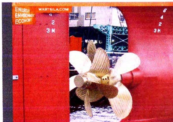
Fig. 4.6 Hélice contrarotante CRP Fuente: WARTSILA
