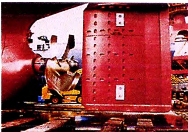
Fig. 4.7 Hélice CLT Fuente: Germanischer Lloyd
