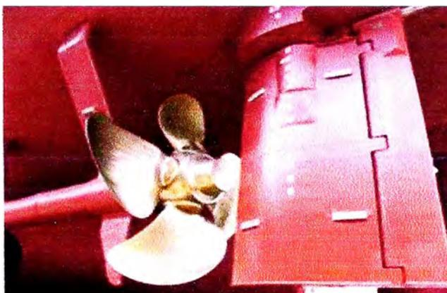
Fig. 3.4 Pala timón con flap. Fuente: Germanischer Lloyd
