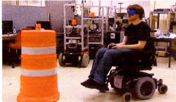
Figura 3.4. Silla de ruedas controlada por comandos de voz.
