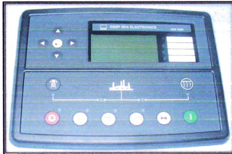
Figura 5.51 módulo de control de transferencia de sincronización deepsea electronic dse 8660
