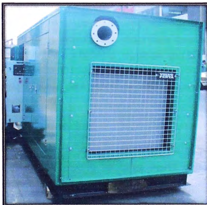
Figura 5.4 Capsula metálica insonorizada de segundo GE GS-350 de 350 KW
