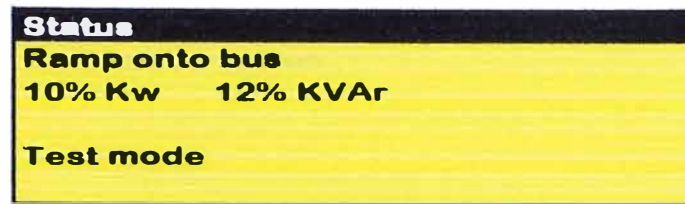
Figura 5.75 carga transferida hacia la red principal
