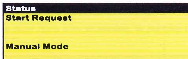
Figura 5.52 inicio arranque de grupos electrógenos en modo manual
