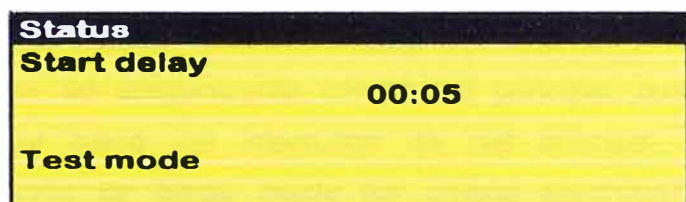
Figura 5.72 arranque de grupos electrógenos en vacío-modo de prueba
