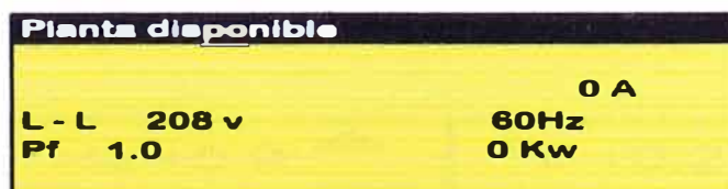
Figura 5.41 frecuencia y voltaje nominales
