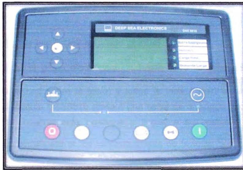
Figura 5.39 módulo de sincronismo deepsea electronic dse 8610
