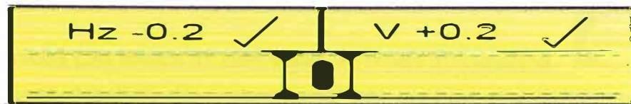
Figura 5.44 frecuencia y voltaje en valores para sincronizar
