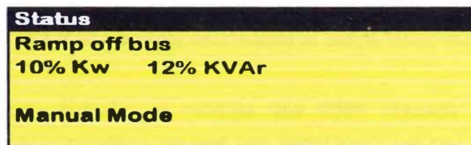
Figura 5.61 carga transferida hacia la red principal
