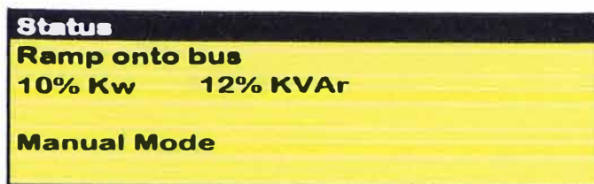
Figura 5.56 carga transferida hacia los grupos electrógenos
