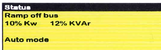
Figura 5.79 carga transferida hacia la red principal-modo automático
