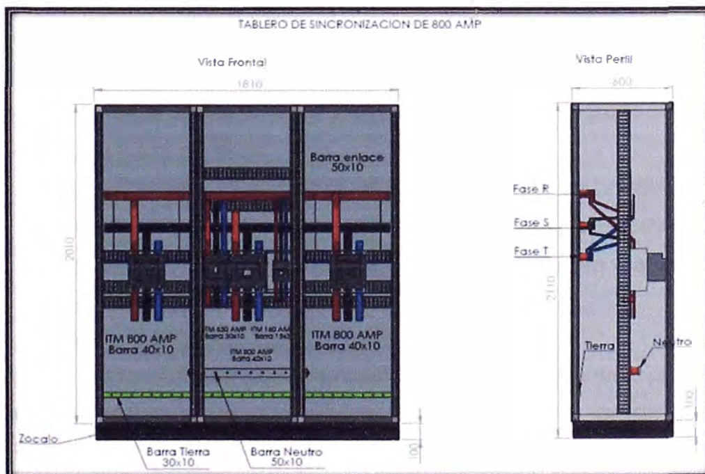
Figura 5.6 Tablero de salida de cargas con ITM 800-630 y 160 amp
