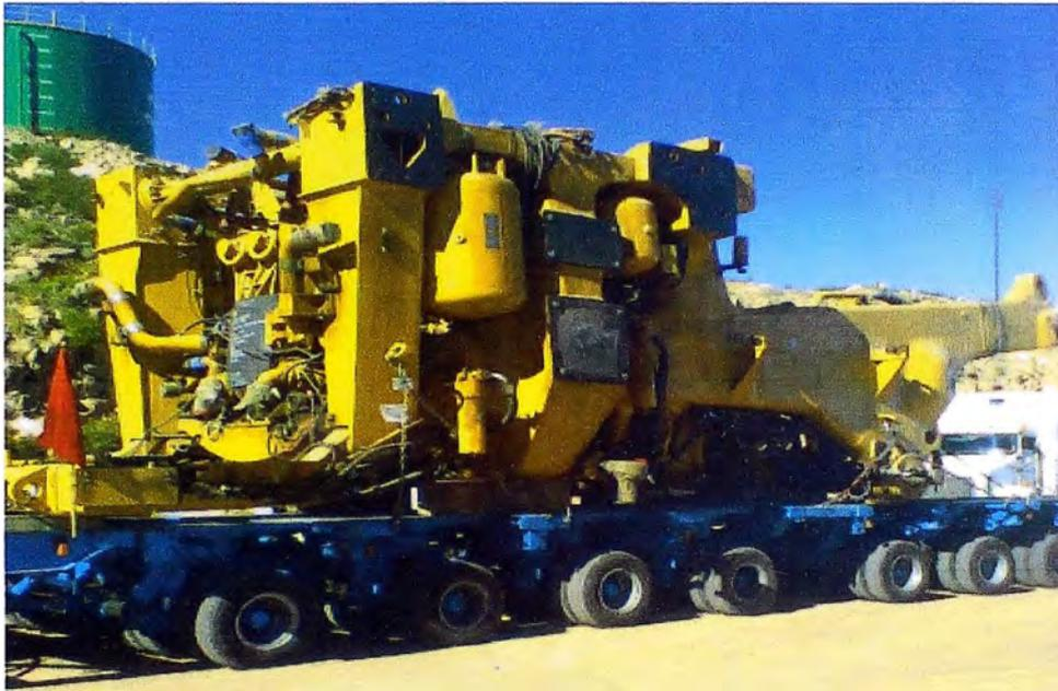
Fig.3,1 Vista típica del chasis del Camión de Obras 797F.
