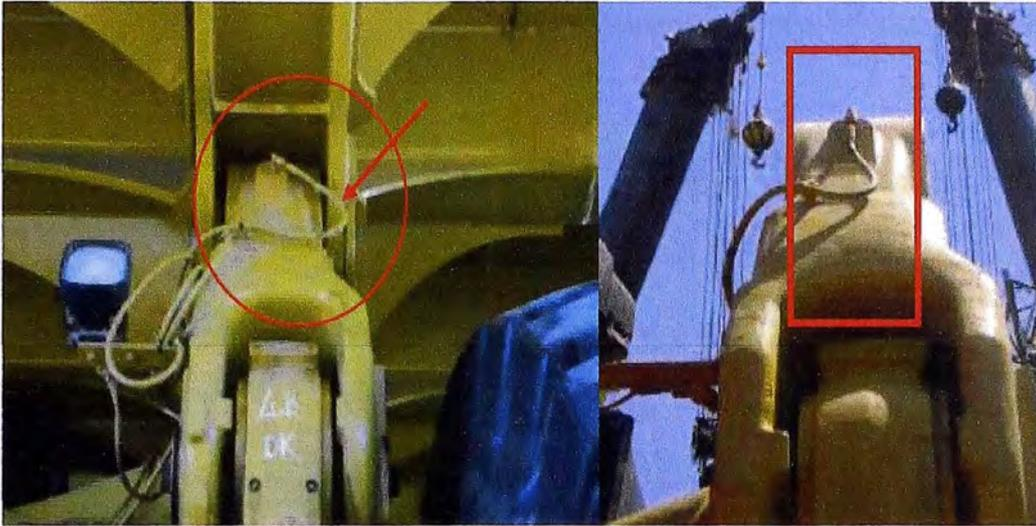
Fig. 3,31 Corrección del ruteo de la línea de grasa del pin de tolva.
