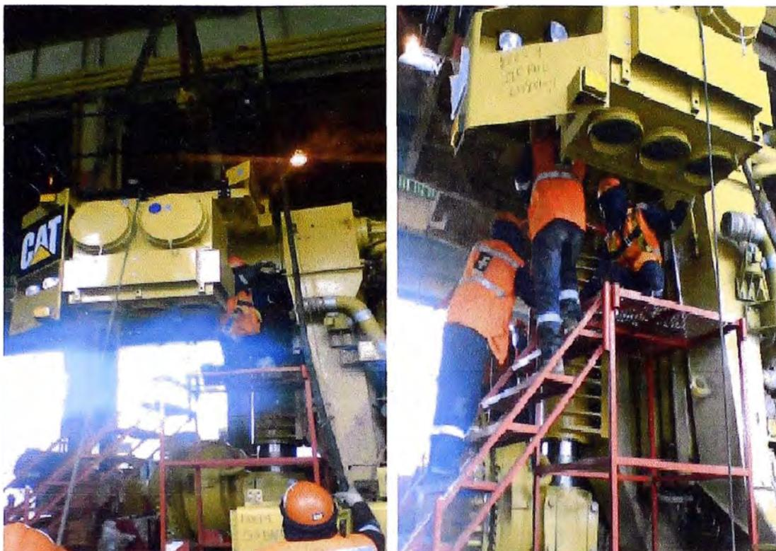
Fig.3,15 Instalación de la plataforma derecha y el grupo de filtros de aire.
