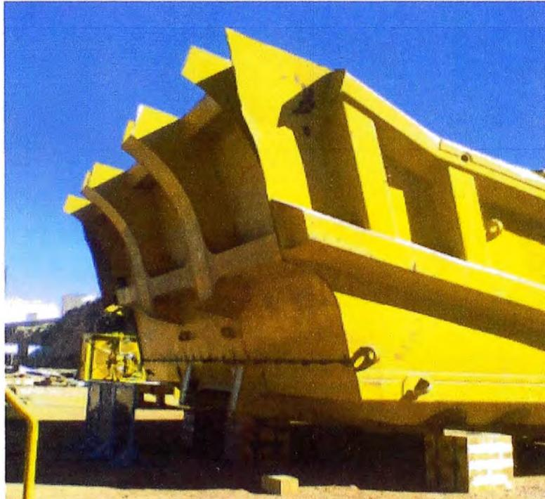
Fig 3,19 Tolva del camión en proceso de ensamblaje.
