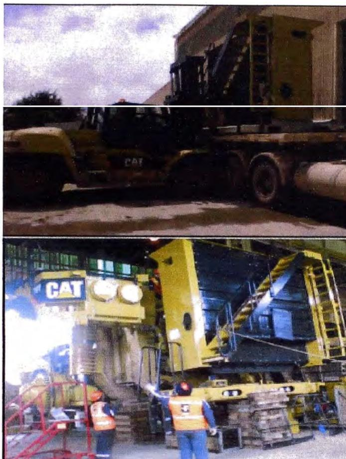
Fig.3,7 Montaje del radiador del camión.
