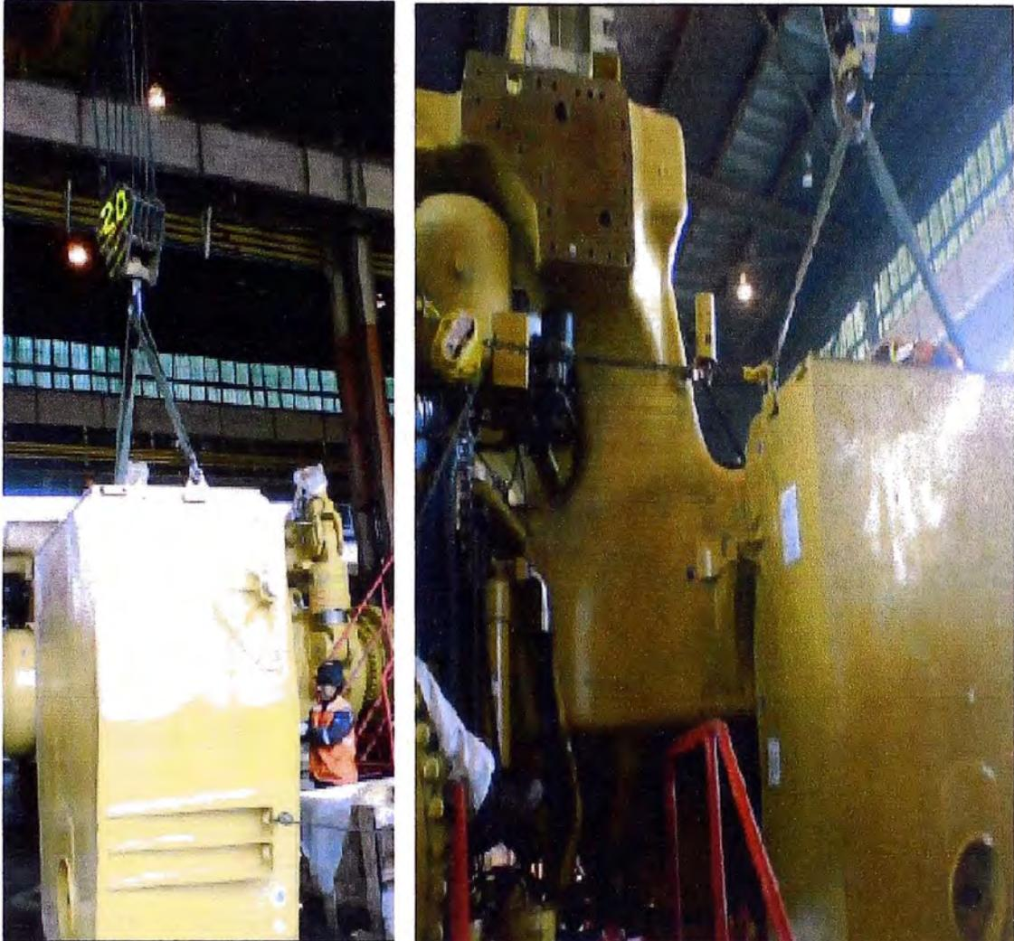
Fig.3,13, Instalación del Tanque de combustible 3.785 L (1.000 gal EE.UU.)
