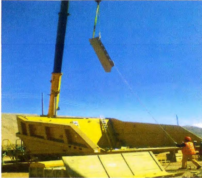
Fig.3,18 Izaje de los plates laterales de la tolva del camión.
