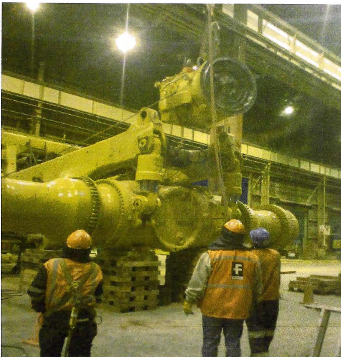
Fig.3,9 Instalación de la transmisión del camión.
