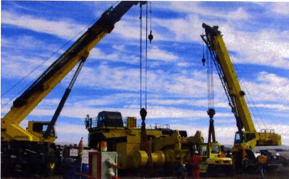
Fig.3,8 Instalación del eje trasero del camión.
