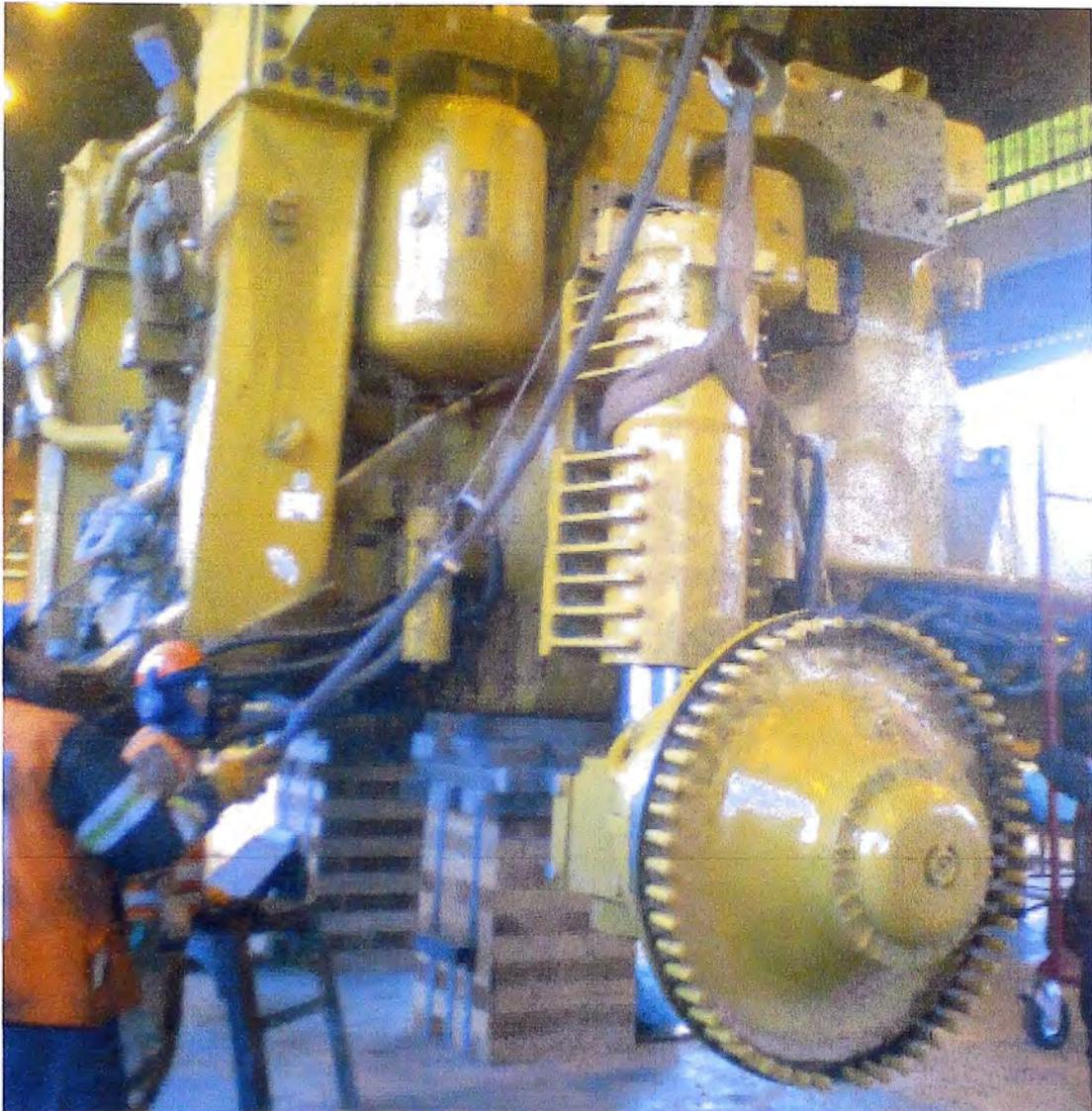
Fig.3,10 Instalación del grupo de rueda y suspensión delantera.
