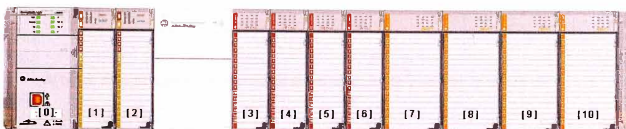
Figura 3.2 Configuración de E/S de PLC
