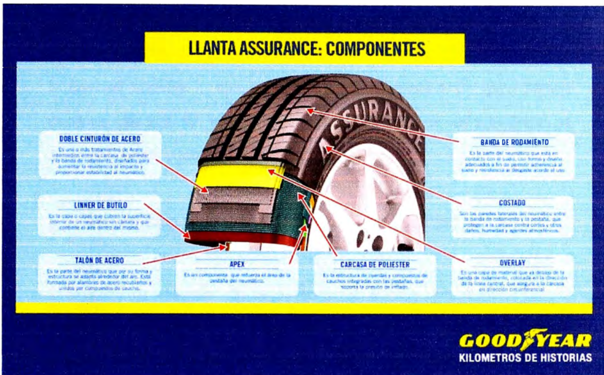
Figura 1.2 Componentes de la llanta radial terminadas
