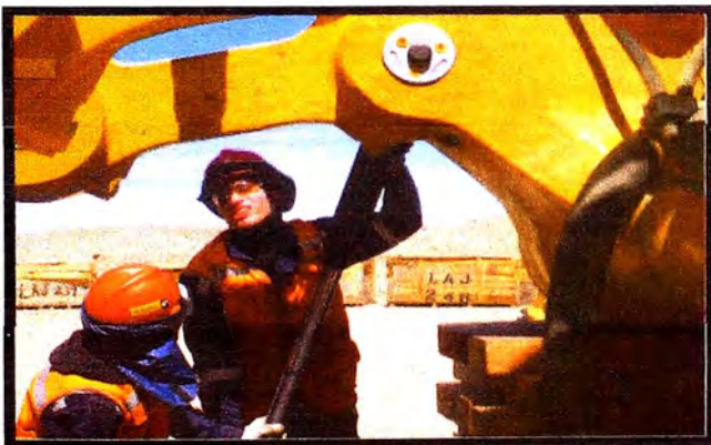
Fig.4.5.4 TORQUE DE PERNOS DEL COLLETS DE LINKS INFERIORES Y SUPERIOR
