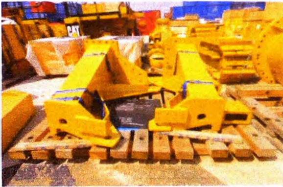
Fig.1.9 Soporte de cabina
