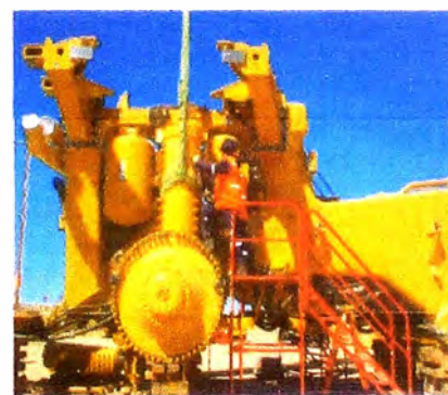
Fig.4.6.3 IZAJE Y MONTAJE SUSPENSIONES DELANTERAS Y TORQUE
