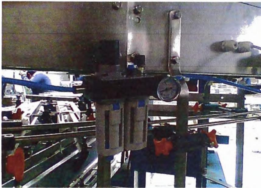
**Fig. 5.14: Unidad de mantenimiento de la línea aerotransportadora**
