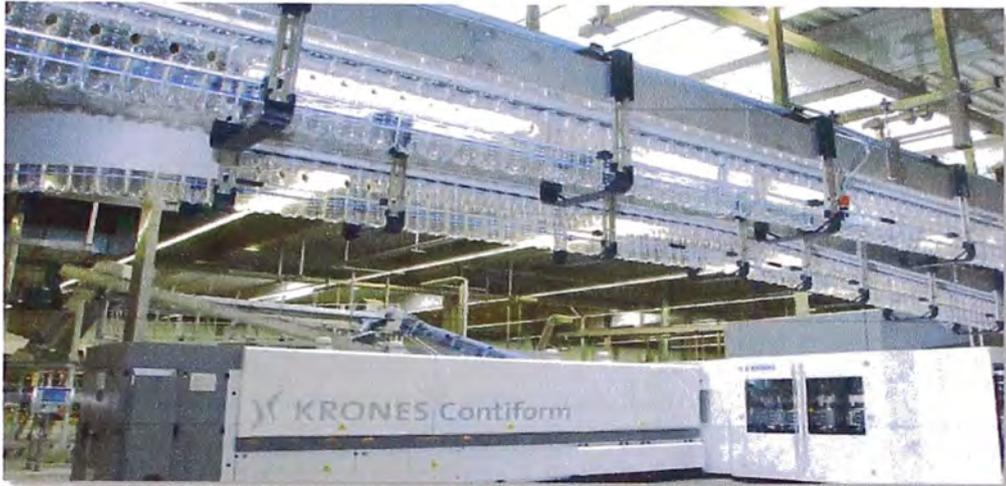
**Fig. 1.2: Saturación de la línea aerotransportadora por los trenes de envases PET**
