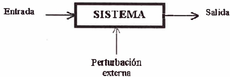
**Fig. 3.1: Sistema básico de control**
