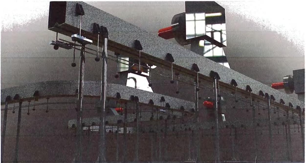
**Fig. 4.3: Representación en 3D de la línea aerotransportadora y sus componentes**
