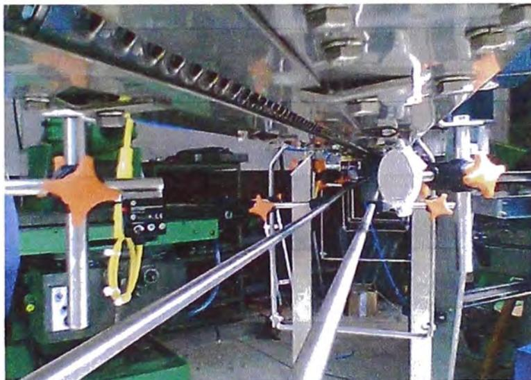
**Fig. 5.20: Instalación de los sensores fotoeléctricos**
