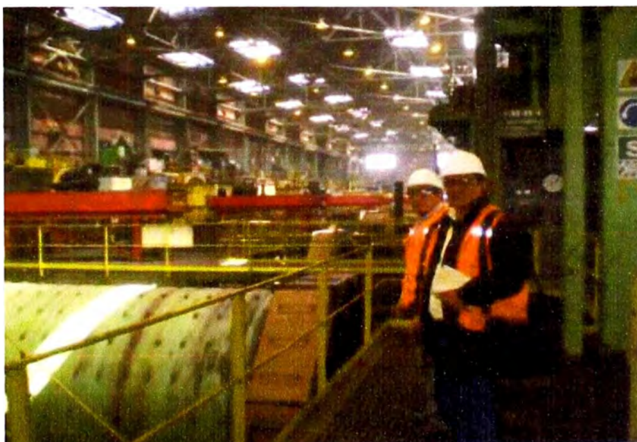
Fig.3.2: Molino de bolas cilíndrico tubular de 14'øx41', Nordberg, para molienda fina y húmeda de mineral de hierro, uno de los 5 instalados en la planta de molienda de una minera nacional del Sur.
