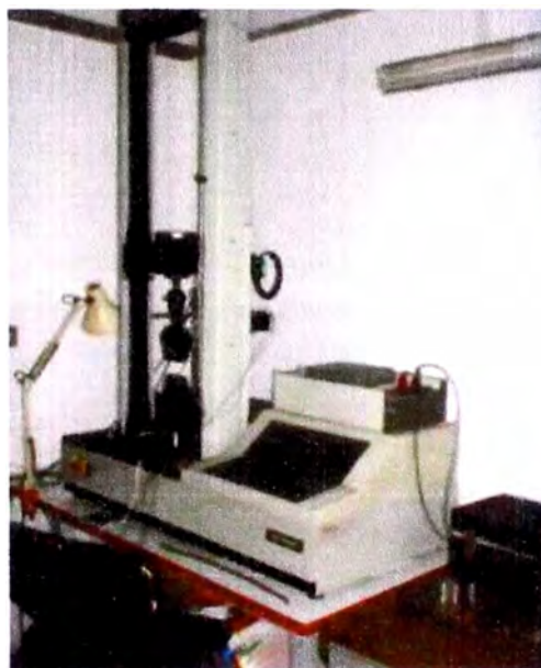
Fig.2.43: Dinamómetro Instron para el ensayo de resistencia a la tracción del caucho.
