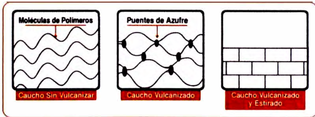
Fig. 2.29: Caucho sin vulcanizar, caucho vulcanizado, caucho vulcanizado y estirado.
