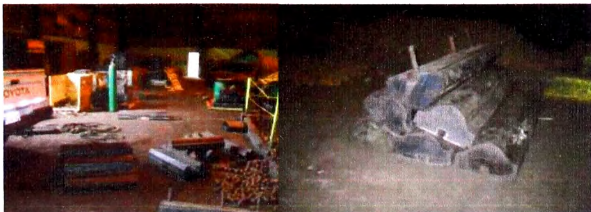
Fig. 4.5: forros placas (forros placas del casco) (Shell plate) y Elevadores (levantadores) (lifter bar) del molino de bolas tipo cilíndrico- tubular de 14'Øx41', Nordberg, para molienda fina y húmeda de mineral:
