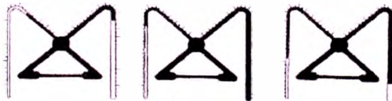
Fig.2.22: Moldes patrón de DuPont para estudio comparativo de fluidez
