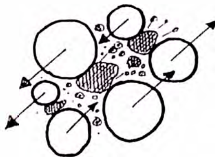
Fig. 3.6 : Mecanismo de molienda de desgaste por rozamiento.
