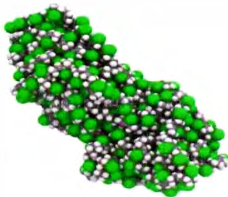
Fig.2.11 Neopreno, (polychloroprene), sintético, caucho, químico, estructura, Átomos, representado, esferas, convencional, Color, coding:, Hidrógeno, (white), carbón, (grey), cloro, (Green)
