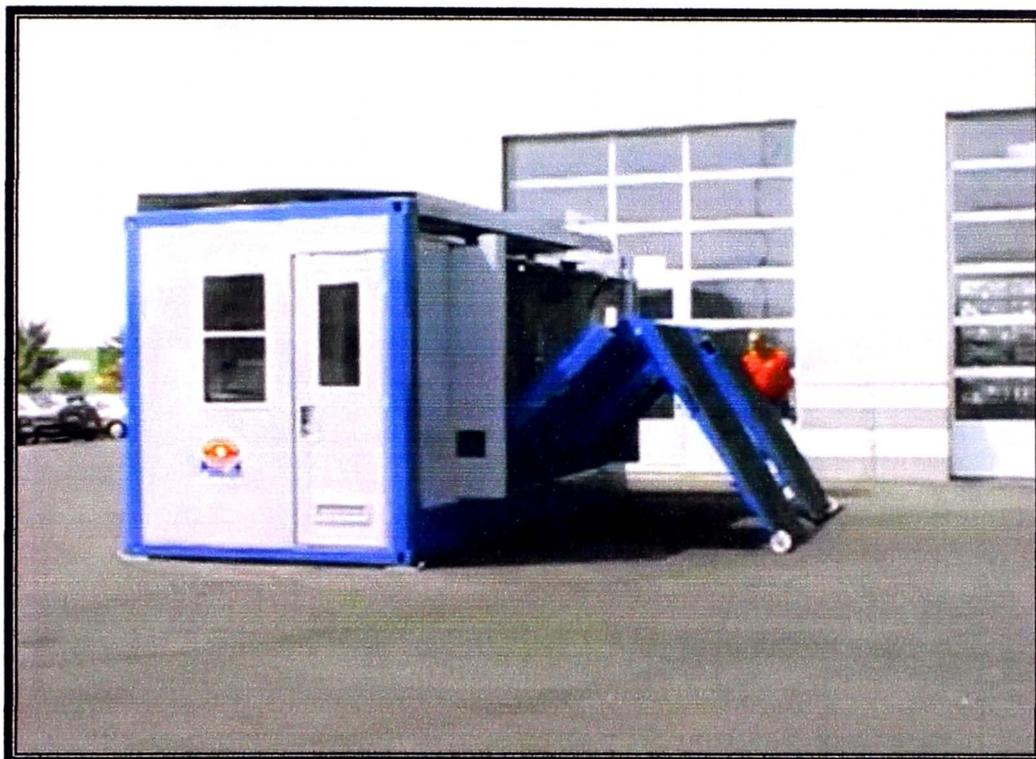
**Fig. N° 6.6: Despliegue de las rampas del CITV Móvil.**
