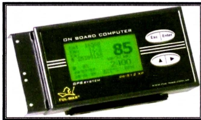
Fig. N° 3.13: Medidor para comprobar el velocímetro.
