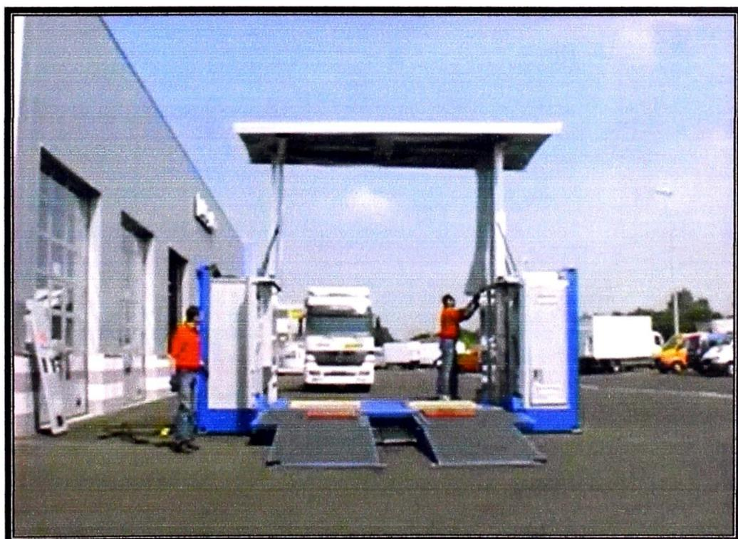
**Fig. N° 6.7: Elevación del techo del CITV Móvil.**
