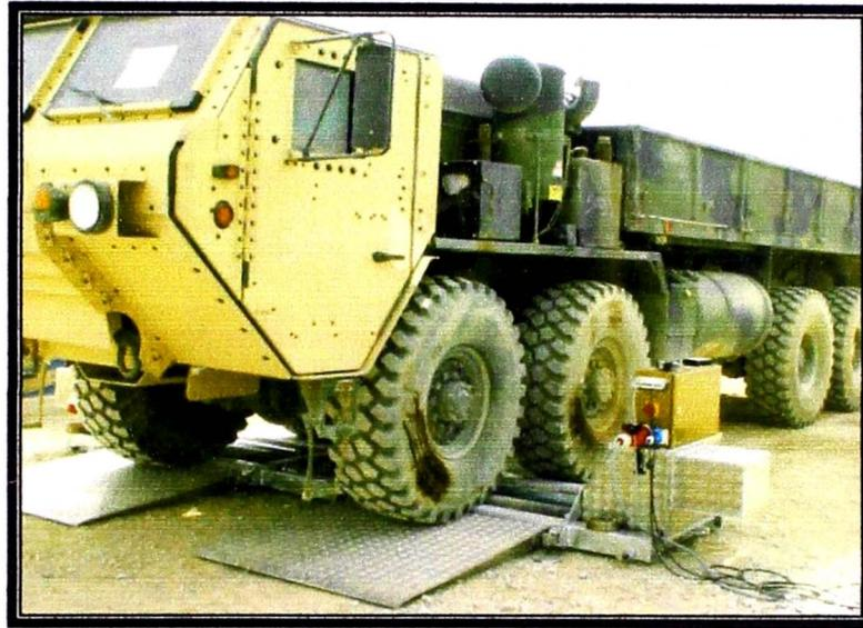
**Fig. N° 6.1: Prueba de Frenómetro en superficie nivelada y compactada.**
