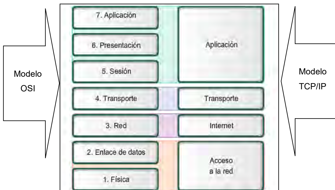
Figura 2.22 Capas del a) modelo de referencia OSI, y del b) modelo TCP/IP (Fuente: Ibídem)
