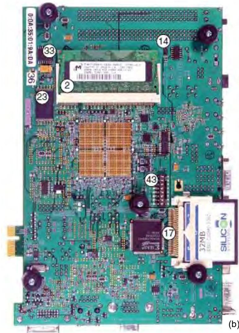
Figura A.2 Componentes de la tarjeta ML505, (a) parte frontal y (b) parte posterior (Fuente: [66])
