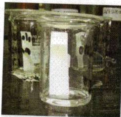
Líquido asciende por el capilar
