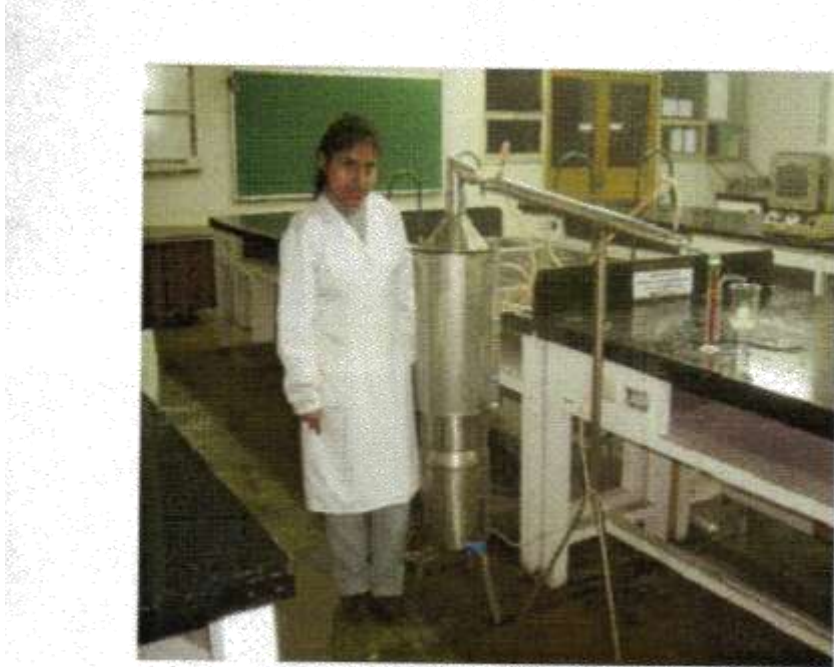
Imagen 3. Equipo de destilación de arrastre de vapor
