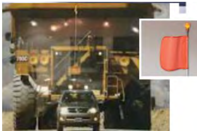
Vehículo ligero con uso de pértiga
