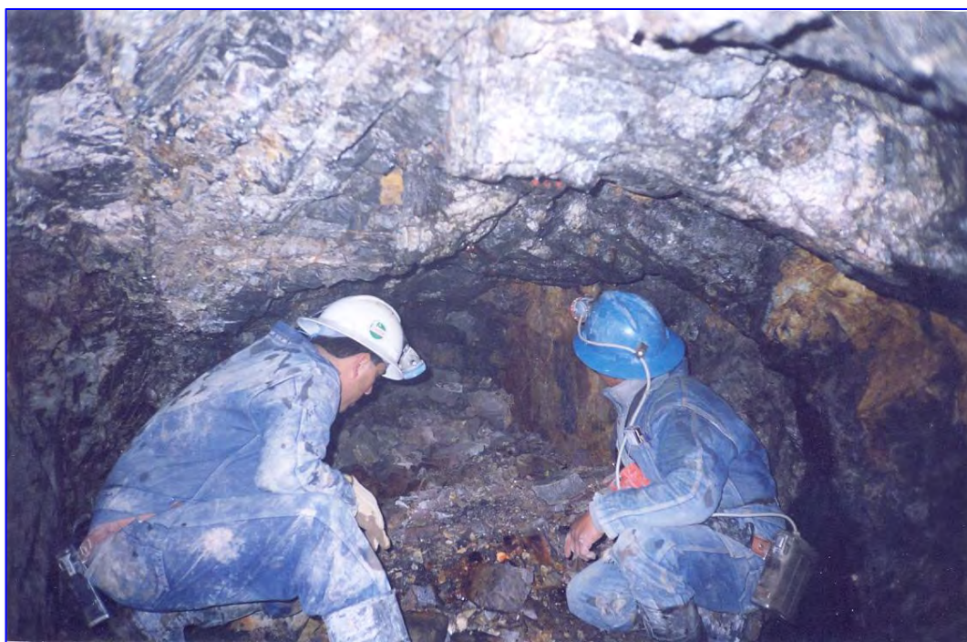
FOTO 16: Galerías parcialmente tapadas por material detrítico.
