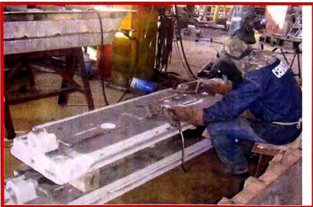
**Fig 5.31 Trabajos de recuperación por soldadura en las guías de chumacera.**
