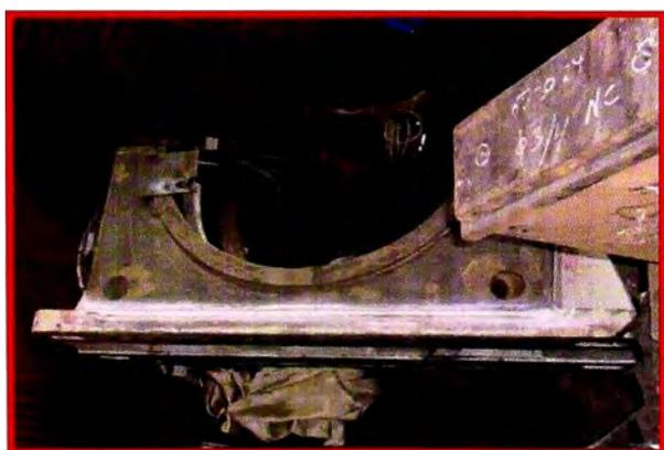
**Fig. 5.27 Detalle de trabajos de soldadura de Carter para sistema de lubricación por aceite**
