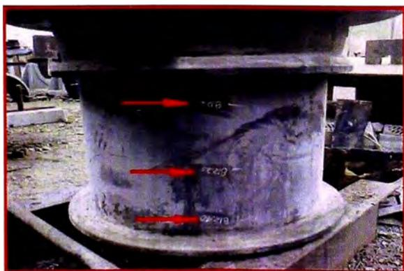
**Fig. 5.22 Rectificar y pulir superficie de rodadura**
