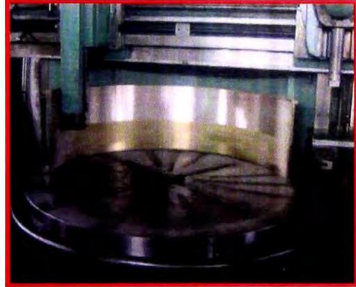
**Fig 5.35 Mecanizado del casquillo superficie interna y externa**
