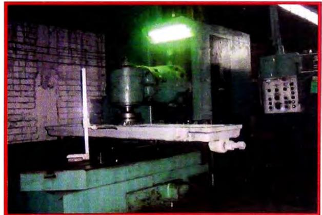
**Fig. 5.32 Trabajo de mecanizado en la mandrinadora sobre la superficie inferior de placa solera.**
