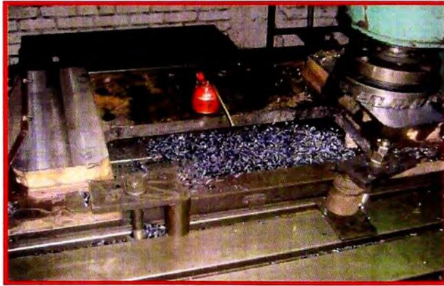
Fig. 5.37 trabajo de mecanizado sobre la Superficie superior del placa solera fabricado.
