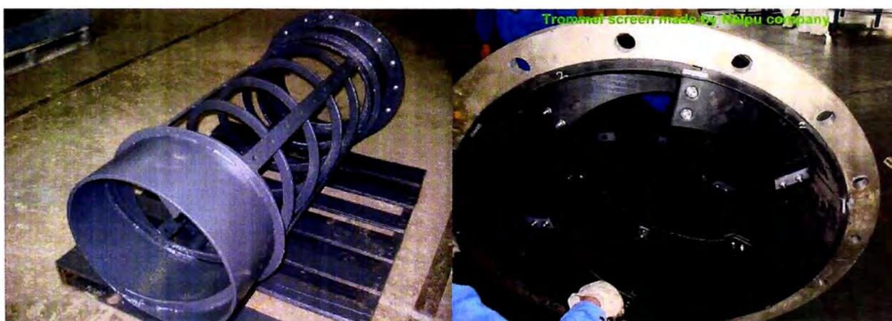
**Fig 2.17 trommel de descarga.**
