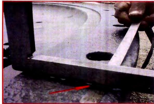
**Fig. 5.18** Desgaste x corrosión (no se aprecia el mecanizado) recuperar x mecanizado para lograr concentricidad.
