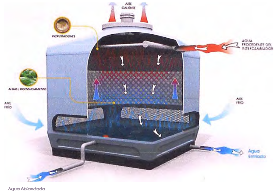
Fig. 2.7 Torre de Enfriamiento
