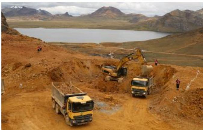
**Figura N° 3.32** Pala y Camiones de 15m<sup>3</sup> Mina Corihuarmi
