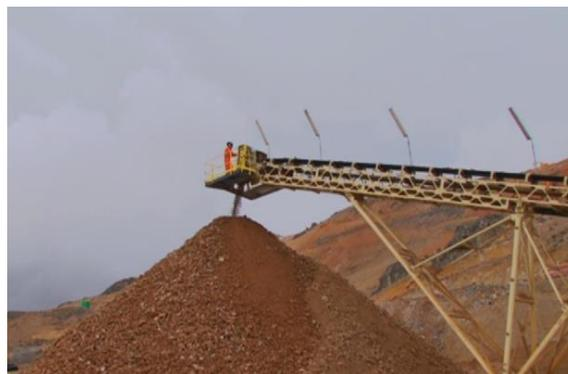
**Figura N° 3.30** Faja con mineral a Chancadora **Figura N° 3.31** Apilado de mineral chancado
