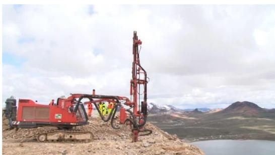
Figura N° 3.23 Perforadora para blast holes -
