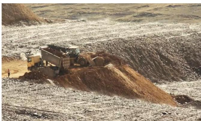
**Figura N° 3.33** Descarga de Mineral y proceso de irrigación en el *pad*. (Mina Corihuarmi)
