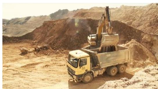
Figura N°3.24 Carguío en camión de 15m<sup>3</sup>
