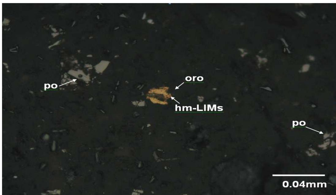
Figura 2.4: Malla -200. Se observa presencia de un grano de oro libre de 20 $\mu$ m, con algunas impurezas de limonitas-hematita.
