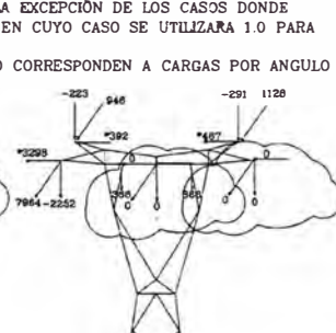
CASO:8 ANORMAL 4(VpRed) PV ESTRUCTURA: 0 daN/M2 FS=1.25
