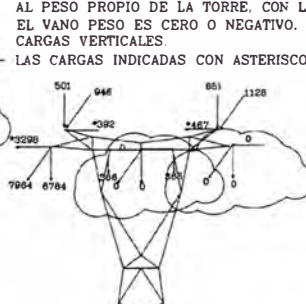
CASO:10 ANORMAL 6 PV ESTRUCTURA: 0 daN/M2 FS=1.25
