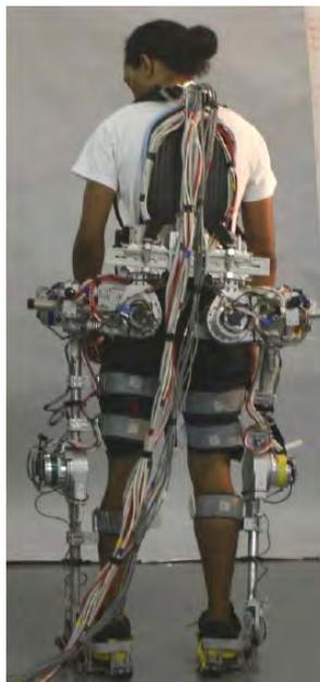
**Figura 1.6:** Movilidad asistida por exoesqueleto, El exoesqueleto tiene tres y dos grados de libertad activos y pasivos por pierna respectivamente, Florida Institute for Human and Machine Cognition.
