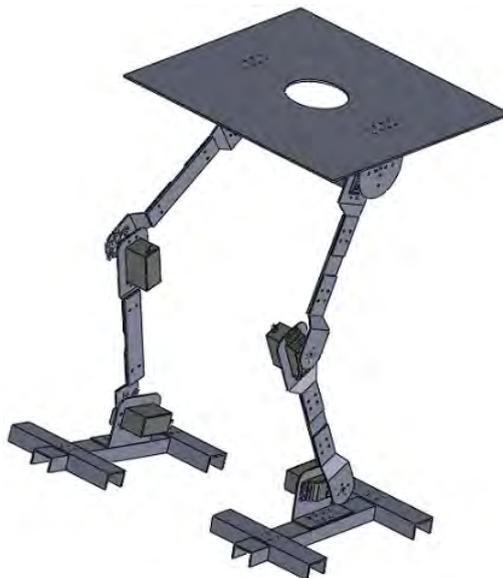
**Figura 5.2:** Diseño del mecanismo prototipo RPY en SolidWorks
