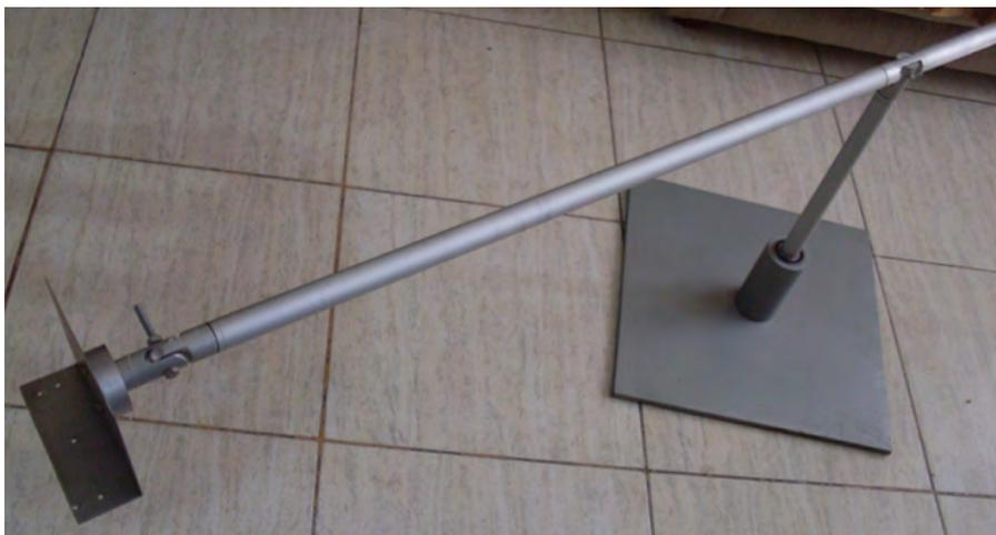
**Figura 5.3:** Mecanismo de soporte transversal, compuesto de dos rodamientos ubicados en las uniones, y dos pines que permiten mayor grado de movimiento
