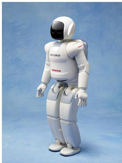
**Figura 1.1:** Robot Asimo (2010) de la compañía Honda, cuenta con 34 grados de libertad, velocidad de desplazamiento de 2.7 km/h
