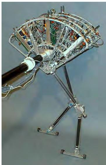
**Figura 1.3:** Spring Flamingo (2000), MIT. Utiliza actuadores elásticos
