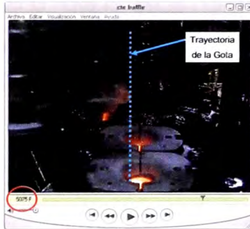
Figura 6.15 – Tapa sobre la trayectoria de la gota
