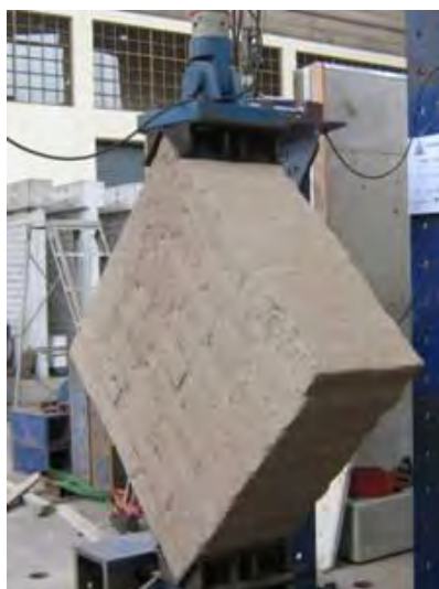
Foto 1.6 – Esquema de ensayo de muretes de adobe.
