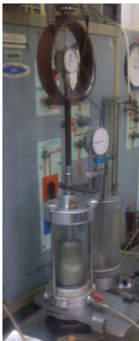
Foto 4.6 – Equipo para el ensayo triaxial (capacidad 500 kgf)
