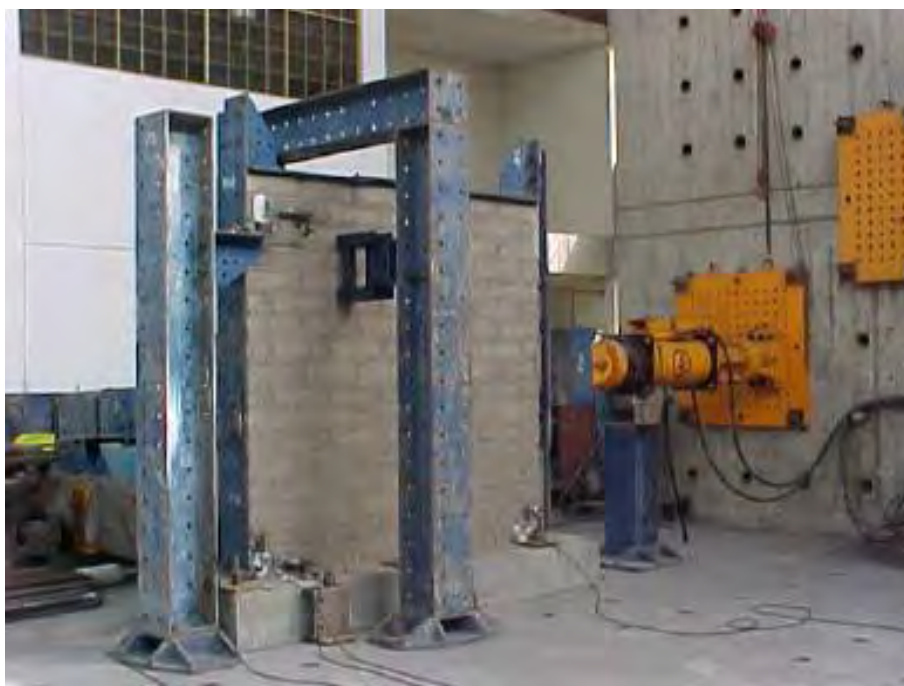
Foto 4.4 – Montaje de equipo en ensayo de muros
