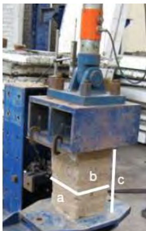
Foto 4.1 – Pila de adobe ensayada indicando nomenclatura de dimensiones
