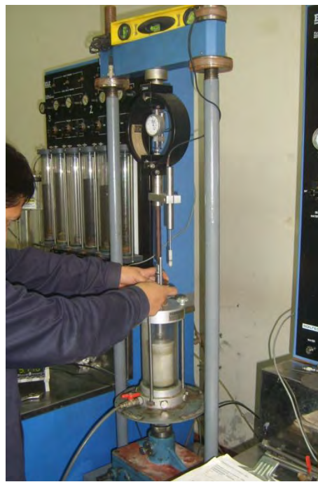
Foto 4.7 – Equipo para el ensayo triaxial (capacidad 2800 kgf)
