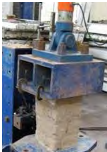
Foto 1.5 – Esquema de ensayo de pilas de adobe.
