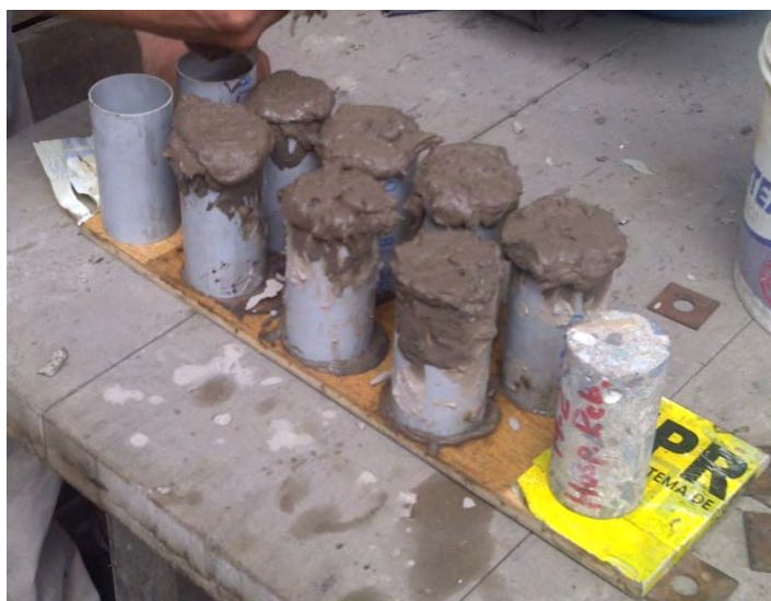
Foto 4.5 – Moldes empleados en la fabricación de las probetas
