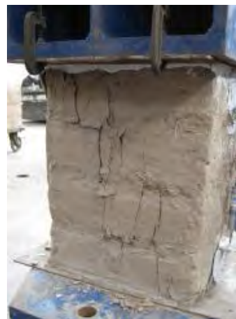
Foto 4.2 – Pila de adobe ensayada
